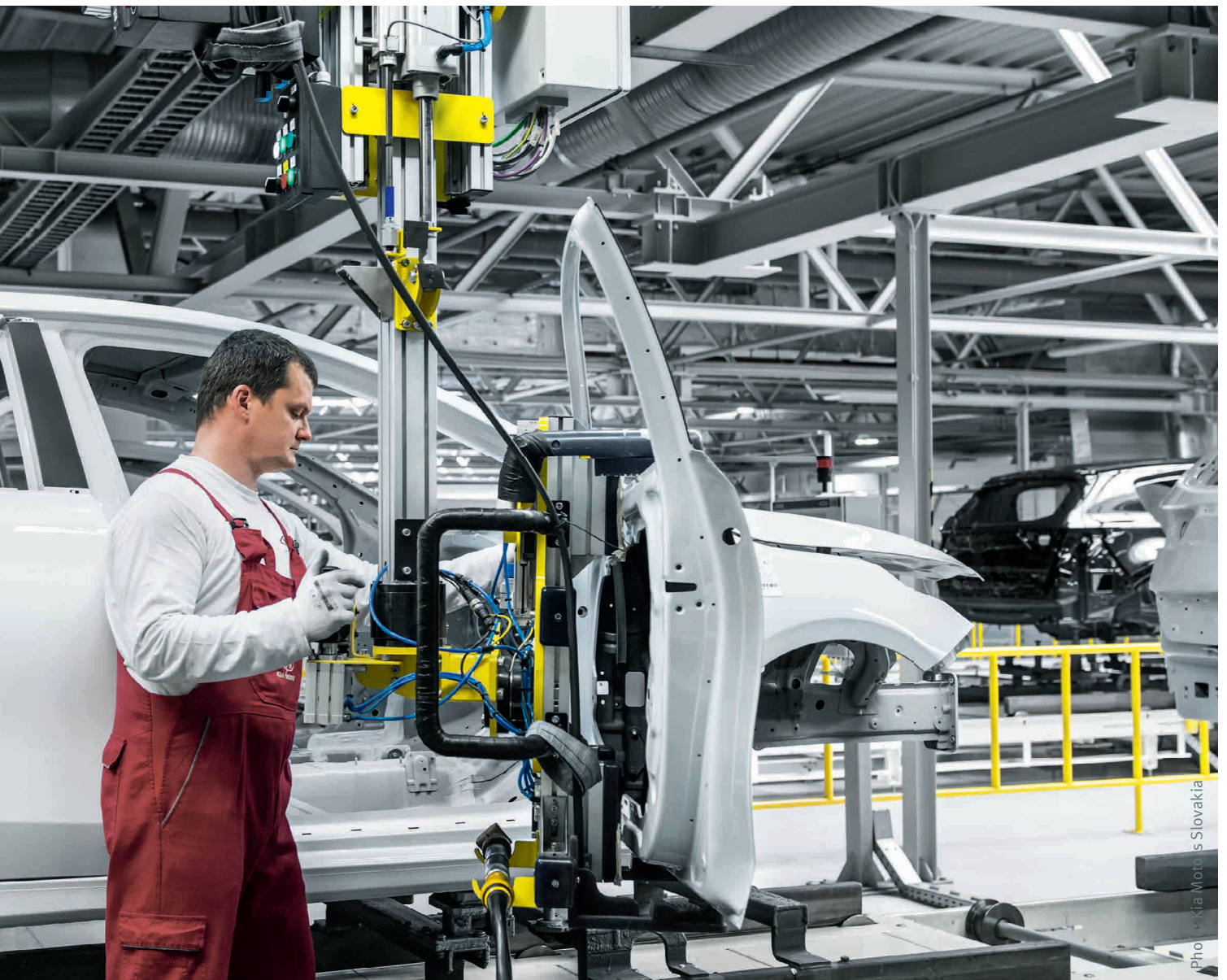
Ein Standard-Balancer-System für sehr individuelle Anwendungen in der Automobilindustrie: hier bei der Montage von Türen.
