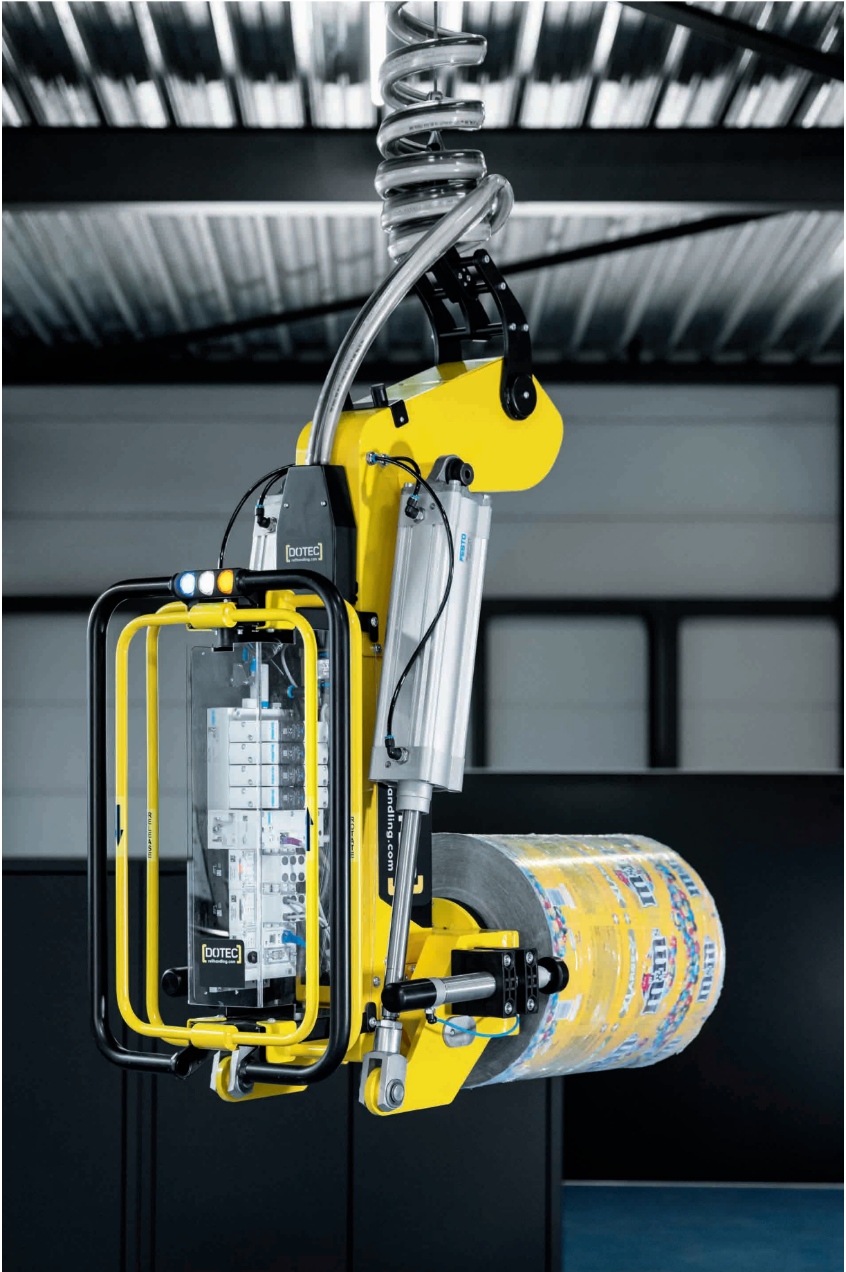
Klemmen, Kippen, vertikales Bewegen: Das über Apps gesteuerte Motion Terminal sorgt für maximale Flexibilität bei allen Bewegungen. Diese sind, wie das Absetzen der Last, sanft und schnell.
