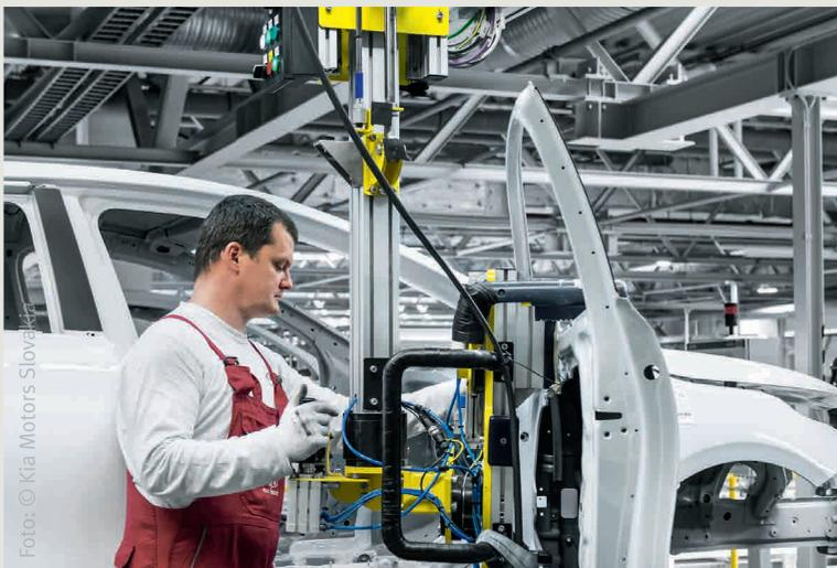
**Flexibel und sicher:** ein Standard-Balancer-System für sehr individuelle Anwendungen in der Automobilindustrie, hier bei der Montage von Türen.
