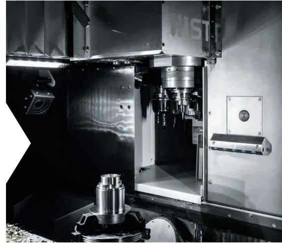
**Sicher geschlossen** – mit dem Festo Motion Terminal VTEM und der Motion App „Soft Stop“ bewegt sich die Werkzeugwechselklappe schnell und gut gedämpft.
