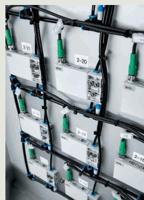
**Klein, leise, leistungsstark:** Proportional-Druckregelventile VEAB regeln hochpräzise den Anpressdruck von Test-Zahnbürsten an Prüfgebissen.
