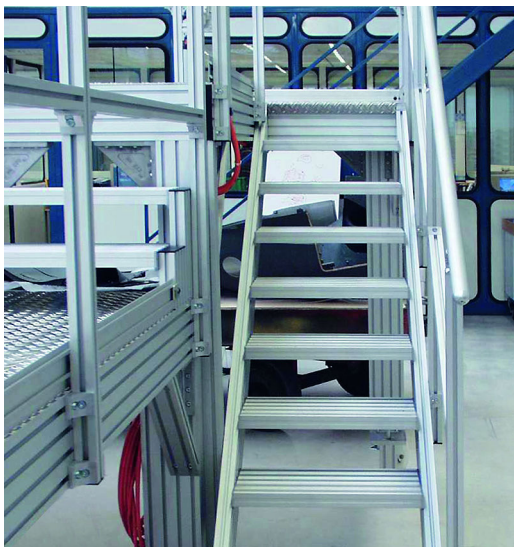
Lasttreppe 45° mit 10 Stufen nach DIN Norm
