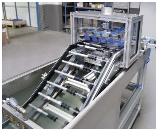
Kundenspezifischer TKU 2040 mit 20° Neigung und Transport durch ein Reinigungsbad
