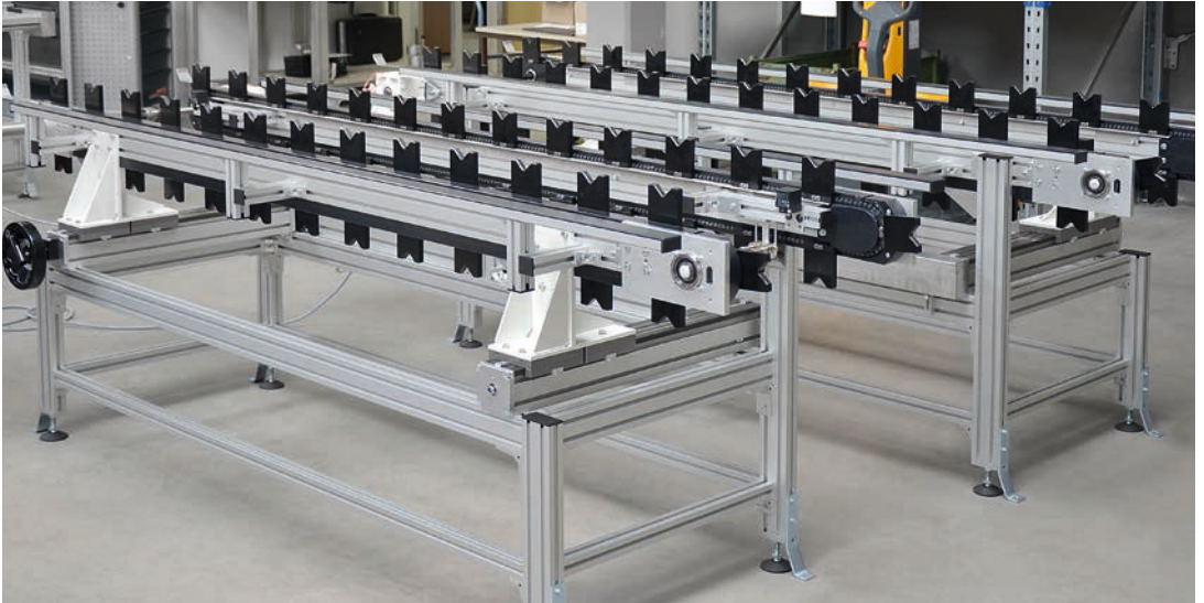
TKU 2040 mit Sonder-Verstelleinheit zum Verstellen des Abstandes der Förderstränge zueinander
