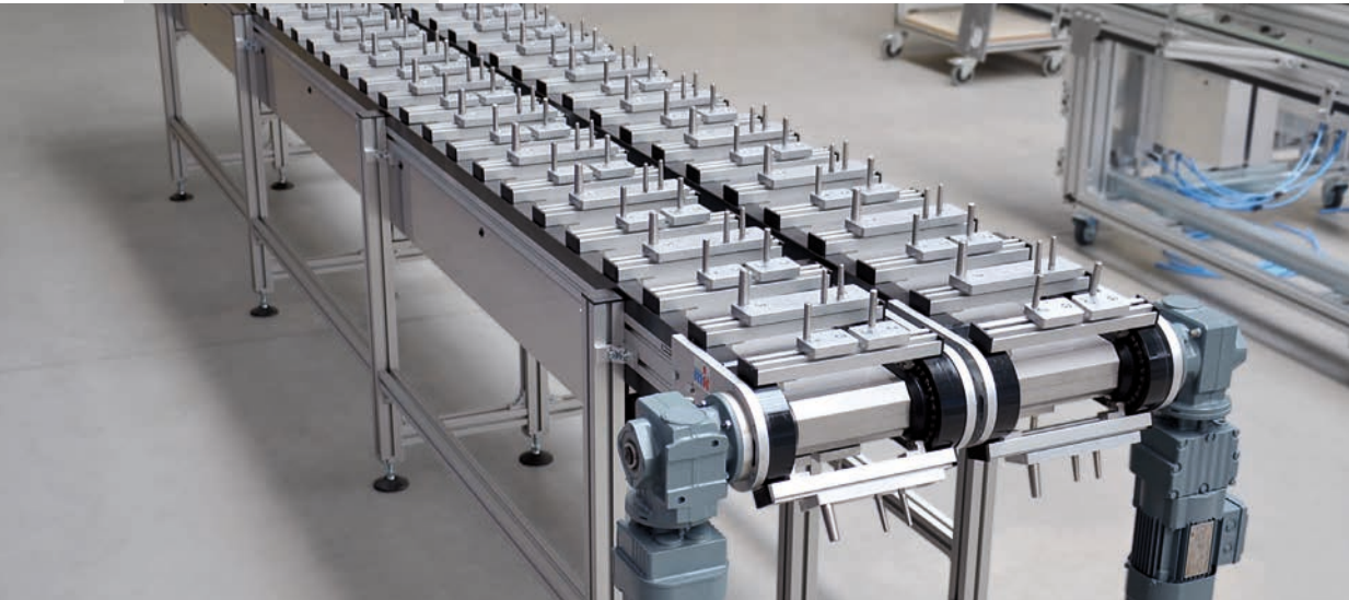
Doppelstrang-System mit auftragspezifischen Profil-WTs und Aufnahmen
