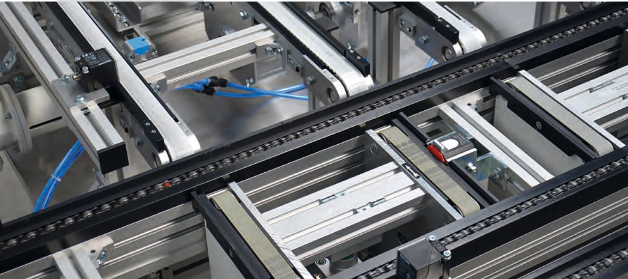
Versamove plus: Ausschleusung der WTs von der Hauptlinie in zwei parallele Querförderstrecken
