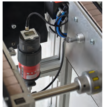
Versamove standard: Zentralschmiereinheit
