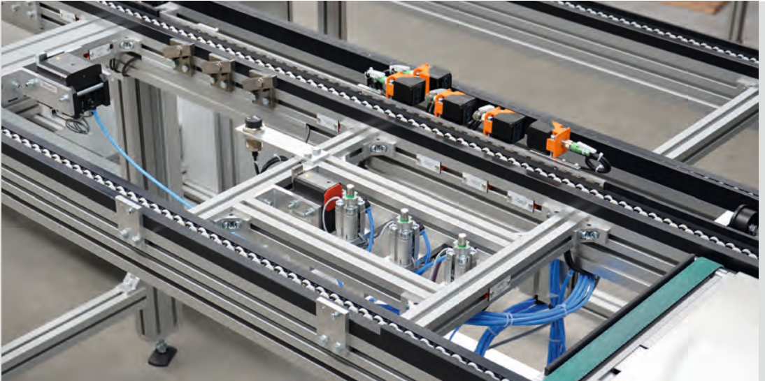
Versamove plus: Kundenspezifische Sonderstoppereinheit mit vier Entnahmepositionen
