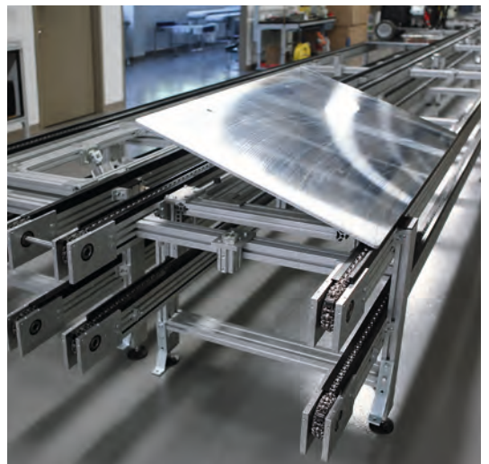
Versamove plus: Zwei Transportebenen, Fördertyp Staurollenförderer
