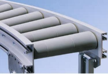
Schwerkraftrollenbahn für den Transport von leichten bis mittelschweren Produkten. Beim System 2065 können überbreite Werkstücke transportiert werden.
