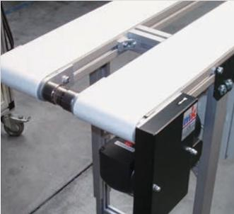
**Antrieb von zwei Förderbändern über einen Motor im Kopfantrieb**
