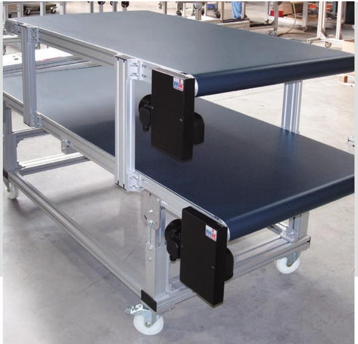
**Zwei GUF-P 2041 in Tandemanordnung mit fahrbarem Ständersystem zur mobilen doppelten Beschickung einer Anlage**
