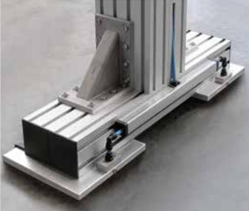
**Podeststütze mit Luftkissen-Transportsystem**
