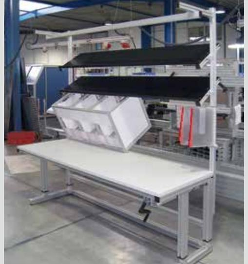
**Hydraulisch höhenverstellbarer Arbeitsplatz mit schwenk- und tiefenverstellbarer Blechablage**
