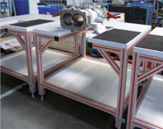
**Montagelinie für Pumpen aus Profilerie 50 mit geschlossenen Profilnuten über Verschlussprofil rot**
