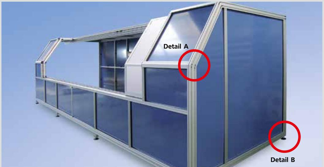
Hierbei handelt es sich um eine Maschinenumhausung für eine manuelle Drehmaschine. Optik und Form der Schutzeinrichtung sollten der Drehmaschine angepasst werden. Damit Späne und Bohrwasser nicht in die Produktionshalle gelangen, wurde die Umhausung mit Blechfüllungen komplett verschlossen. Zwei untereinander verfahrbare Schiebetüren ermöglichen den einfachen Zugang zur Bedienung der Maschine. Die Schiebetüren werden mittels Zahnriemen elektrisch angetrieben.
