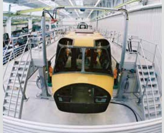
**Podest um Wartungs- und Montagearbeiten an Helikoptern einfach und gefahrlos durchführen zu können**
