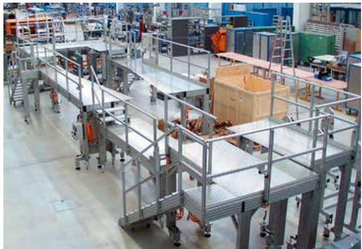
**Freitragende Montagebühne, 15 Meter lang, mit Lasttreppen für sicheren Halt bei hohen Belastungen**
