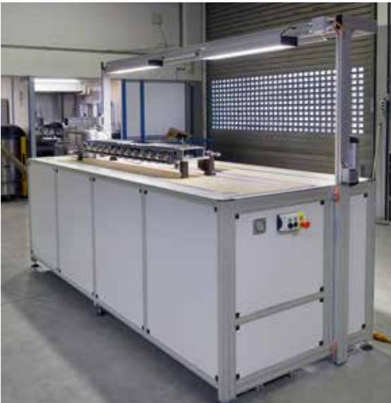
**Montagearbeitsplatz mit Absenkvorrichtung über elektrisch angetriebene Hydraulikzylinder**
