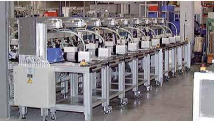
Prüfstand für Vakuumpumpen
