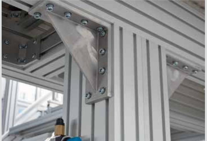
Sehr stabile Verbindung mittels Gusskonsole, Konsolen sowie Trägerprofile sind für alle Profilerien lieferbar
