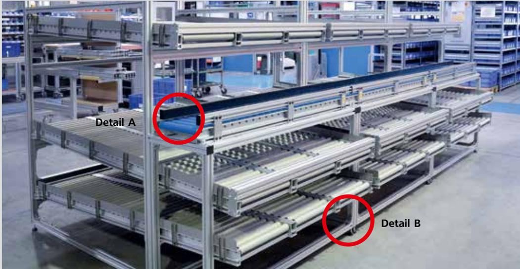
Dieser Kanban Arbeitsplatz dient zur Kommissionierung variabler Baugruppen. Dabei werden die passenden Einzelteile aus der Kanban-Bereitstellung entnommen. Leere Einzelteilkisten werden auf der unteren Schwerkrafttrollenbahn als Anforderung zur erneuten Befüllung nach hinten zurück geführt. Das Gestell wurde aus Profilen der Serie 40, passend an die Anforderung und ergonomisch gestaltet.
