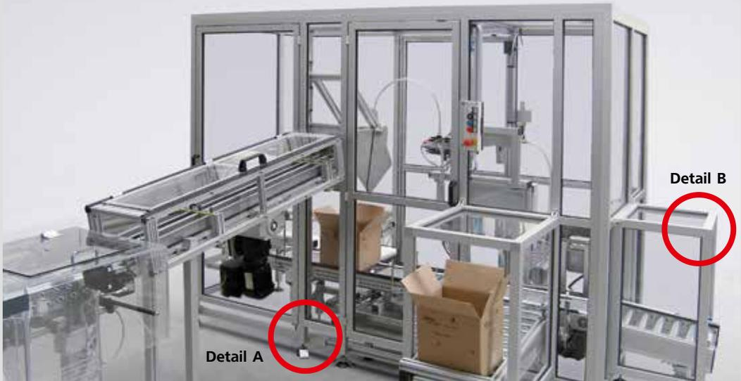
Schutzumhausung für Anwendungen in der Kosmetikindustrie. Aufgrund der hohen Hygieneanforderungen wurde die Maschinenumhausung aus Reinraumprofilen der Serie 40 mit verschlossenen Profilnuten gebaut. Um einen freien Blick auf die Verpackungsstation zu haben, wurde das Flächenmaterial in kratzfestem Makrolon ausgeführt. Außerdem wurden Edelstahlstellfüße eingesetzt, die für die Einsatzbedingungen unter den geforderten Hygienevorschriften ideal sind.
