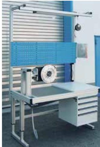
**Service Montagetisch mit arretierbarer Dreheinheit für Vakuumpumpen**
