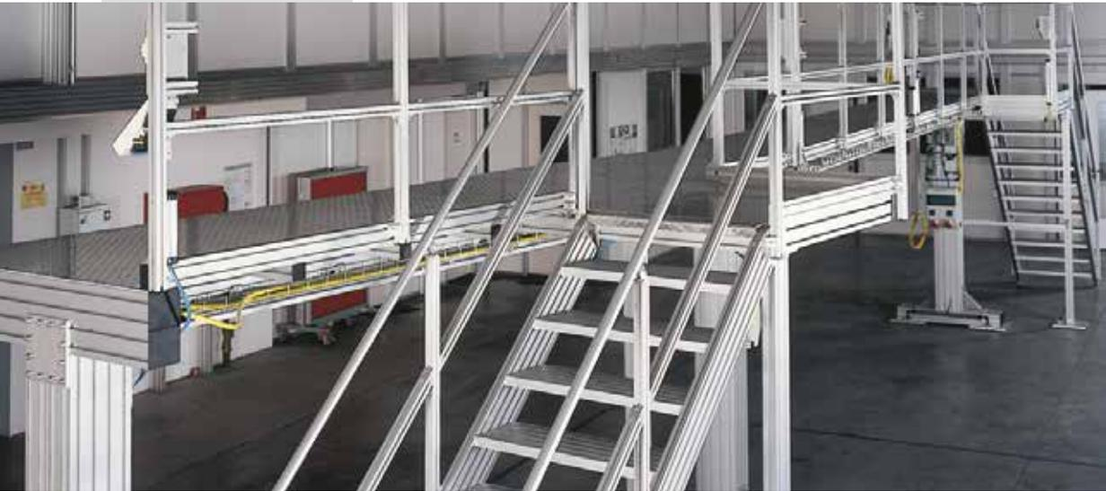
**Montagebühne für Helikopter, Luftkissen-Bodenelemente ermöglichen ein müheloses Verschieben der Gesamtkonstruktion auf dem Hallenboden**
