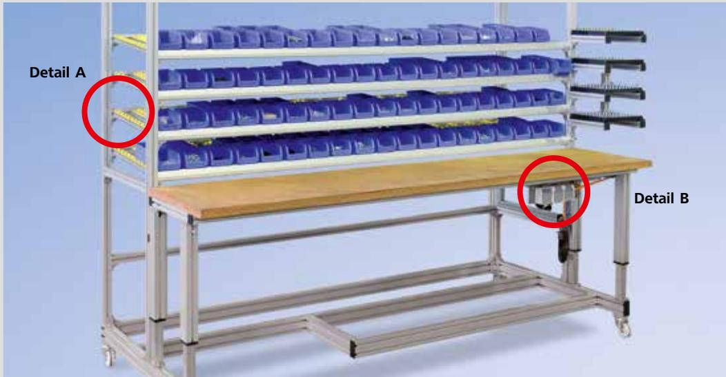
Für Monteure ist es wichtig alle benötigten Einzelteile direkt am Arbeitsplatz greifbar zu haben um eine schnelle und einfache Montage zu gewährleisten. Ist eine Greifkiste leer, wird diese entnommen und befüllte Kisten laufen nach. Werden zur Montageerleichterung elektrische/pneumatische Werkzeuge benötigt, können diese an den vorhandenen Steckdosen und Pneumatikanschlüssen betrieben werden.
