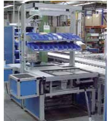
DFT-Fließmontagelinie für Vakuumpumpen
