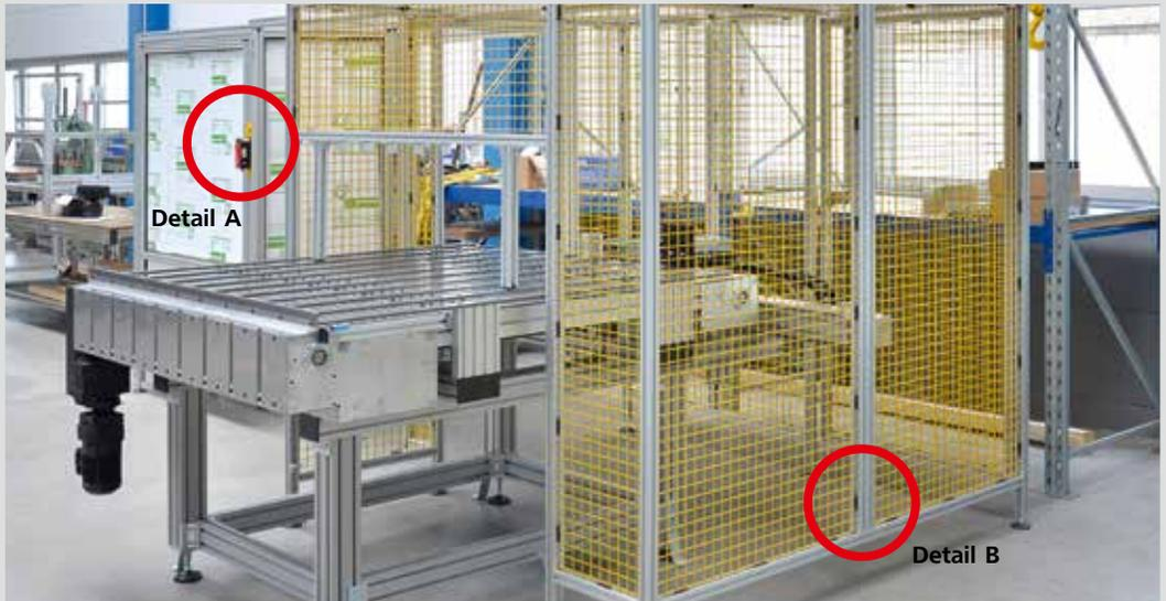
Die Greif- und Übergabestation der Anlage wird durch umlaufende Feldrahmen mit Schweißgitter im kundenspezifischen RAL-Ton geschützt. Der Einlauf und die Messzelle wird durch Feldrahmen mit Polycarbonat und Verkleidungsblech geschützt. Neben der Flügeltür wurde auch eine platzsparende Falttür eingebaut.
