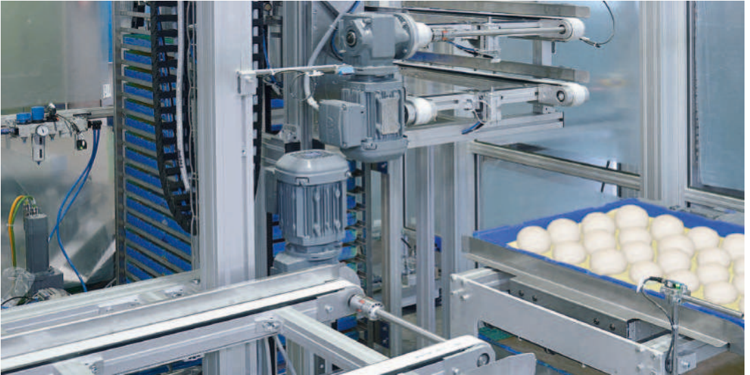
Verkettung ZRF-P 2010 als Be- und Entladestation für Brötchenanlage mit Stapleinrichtung als Puffer
