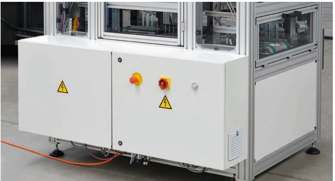
Schaltschrank an der Gestell- und Schutzeinrichtungskombination angebaut
