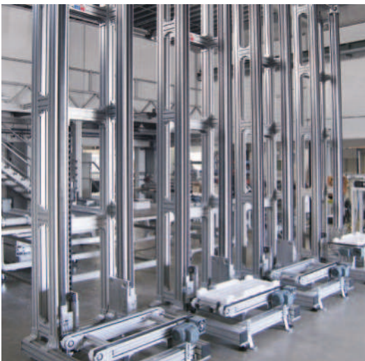
Doppel-LZR 2005-38.44 mit Ausleger für Doppel-ZRF-P 2010 als Lift und Abgabe aus Doppel-ZRF-P als Übersetzer
