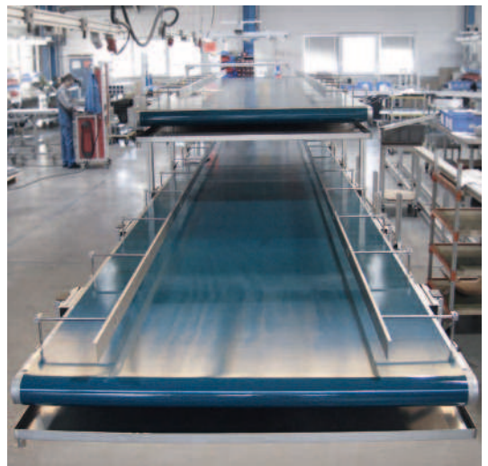
GUF-P 2004 mit Kopfantrieb AS, seitlich außerhalb als 2 Ebenen Förderer mit Auffangwannen auf gemeinsamen Grundgestell
