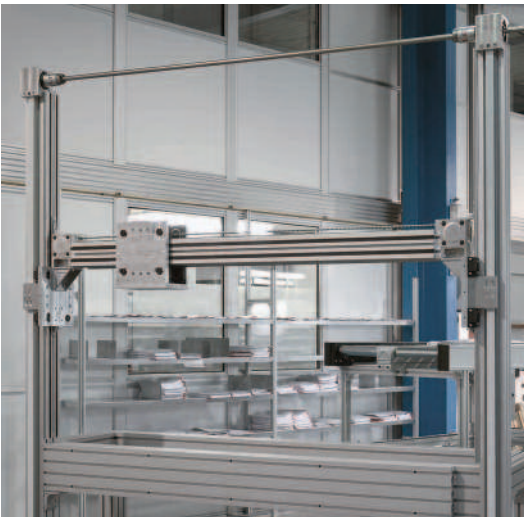
2-Achs Linearmodul aus LZR 2011-38.44.30 mit seitlichem Plattenlaufwagen
