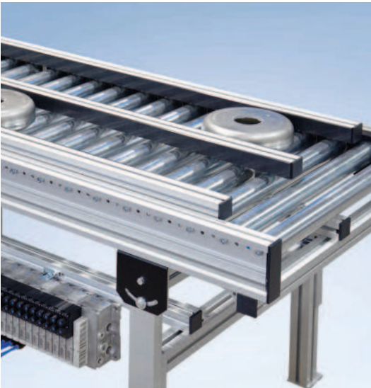
Rollenbahn Tangentialkette RBT-P 2255 mit Verteilerweiche oberhalb des Förderers
