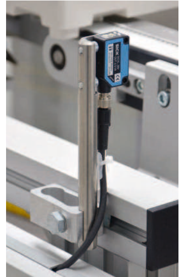
Lichtschranke mit einstellbarem Halter
