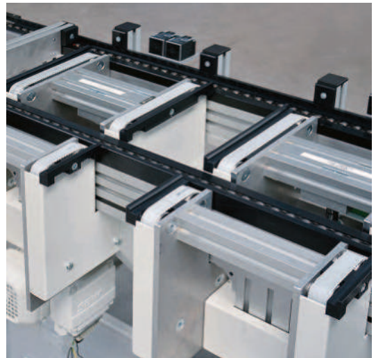
Hub-Querförderer mit gekoppeltem Antrieb und zentralem Hub, zur Überbrückung sehr kurzer Querstrecken
