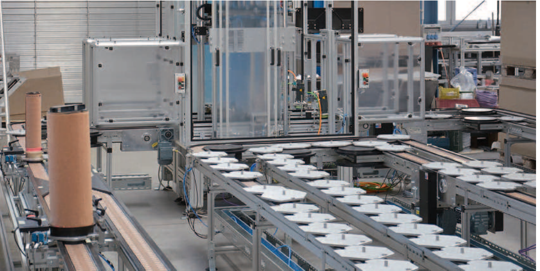
Automatisierte Verkettung mit Werkstückträgern inkl. Drehen, Stoppen, Vereinzeln und Zentrieren auf Basis von Scharnierbandförderern
