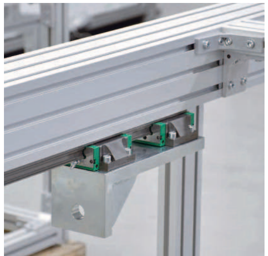
Gestell für Knickversuche anhand von Kugelumlaufführung KU 30.10
