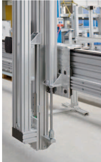
Horizontalachse mit geschäumtem Kombiprofil zur Versteifung
