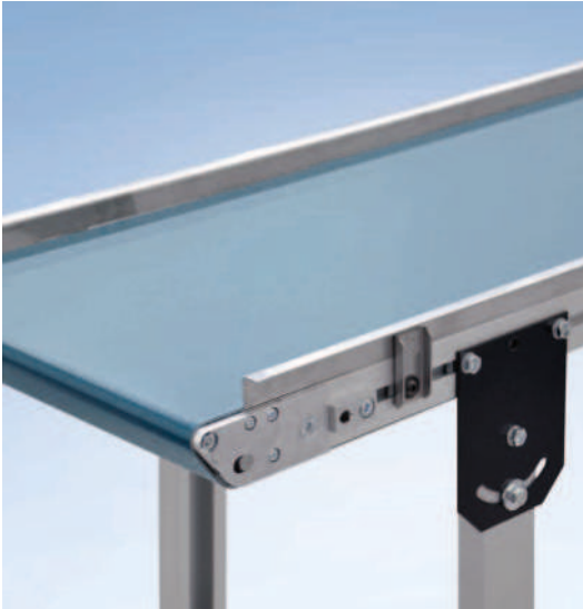
Gurtförderer GUF-P 2000 mit Umlenkung 13 \varnothing 19 mit rollender Messerkante und Seitenführung SF2.2
