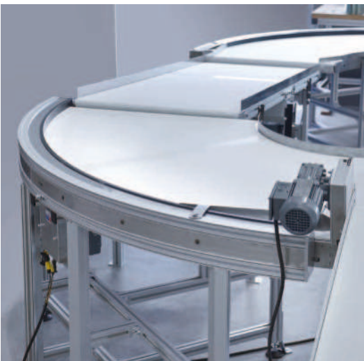
Kombination aus zwei 90° Kurvengurtförderern KGF-P 2040 mit Untergurtantrieb BI, reversierbar
