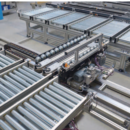
RBT-P 2255 Rollenbahnen als Speicherförderer mit zentralem Be- und Entladehandling
