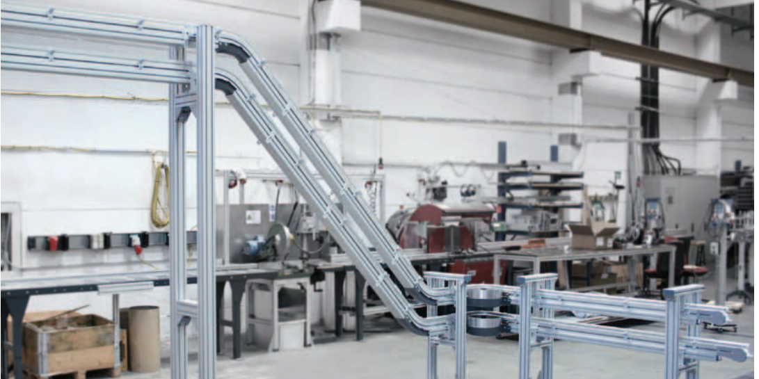
Versaflex SBF A06 mit Scharnierbandkette mit Mitnehmern für den vertikalen Transport
