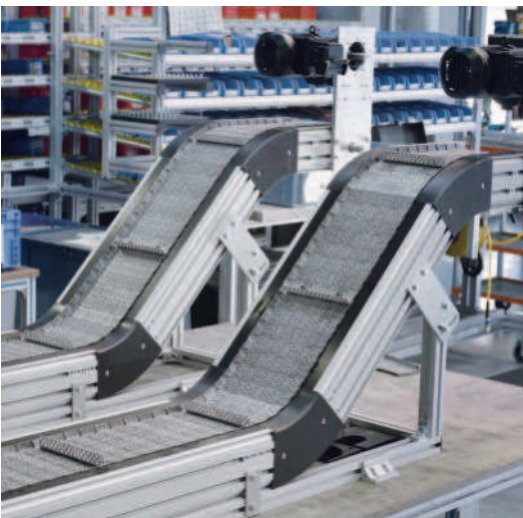
KFM-P 2040.86 SB Kopfantrieb AC mit gelochter Modulbandkette, Querstollen und Noppen zur besseren Produktmitnahme
