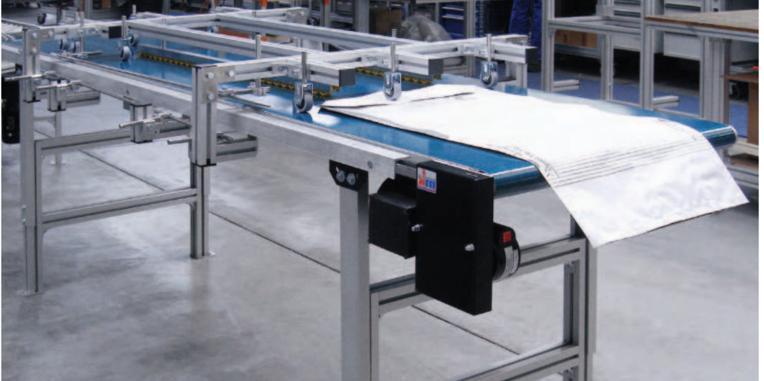
GUF-P 2000 mit Mechanismus zum Falzen und Aufrichten von Papiersäcken vor dem Befüllvorgang
