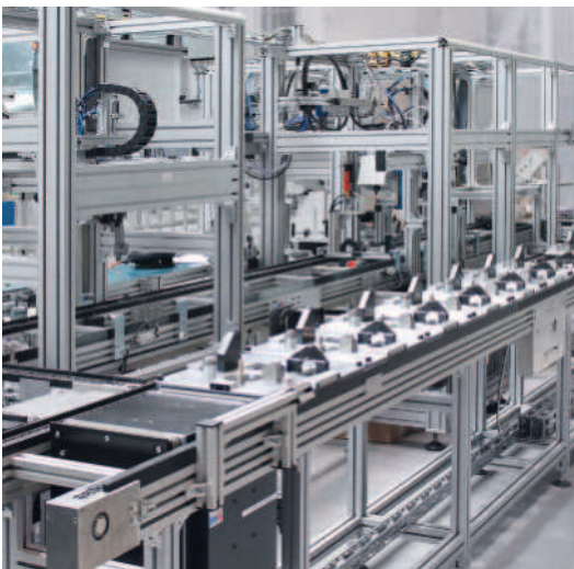
Schlüsselfertiges Werkstückträgersystem Versamove plus mit Montageautomation
