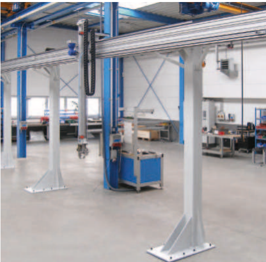
X-Z-Portal mit Greifer zum Umsetzen von Kurbelwellen. X-Achse als LZR mit Stützrolle und Zahnriemen, Z-Achse mit Zahnriemen-Omegaantrieb und Fallsicherung
