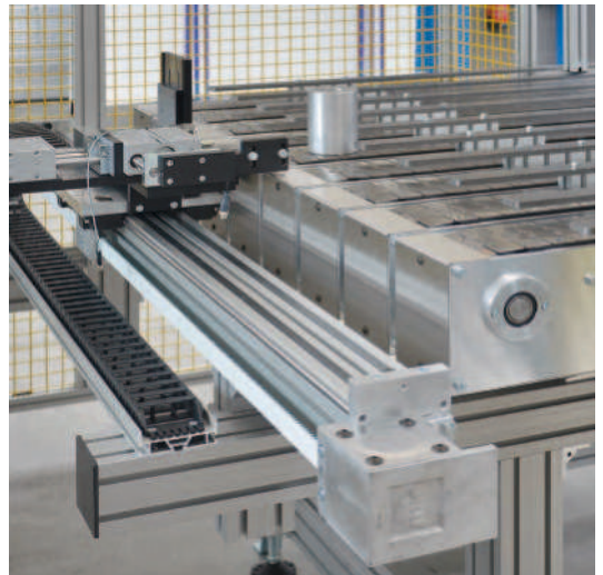
Linearachse aus Linearmodul LZR 2005-38.44-30 mit fahrbarem Greif- und Übergabesystem
