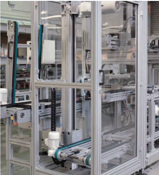
Elektrisch angetriebener Lift in „Stand alone“ Gestell mit Schutzeinrichtung
