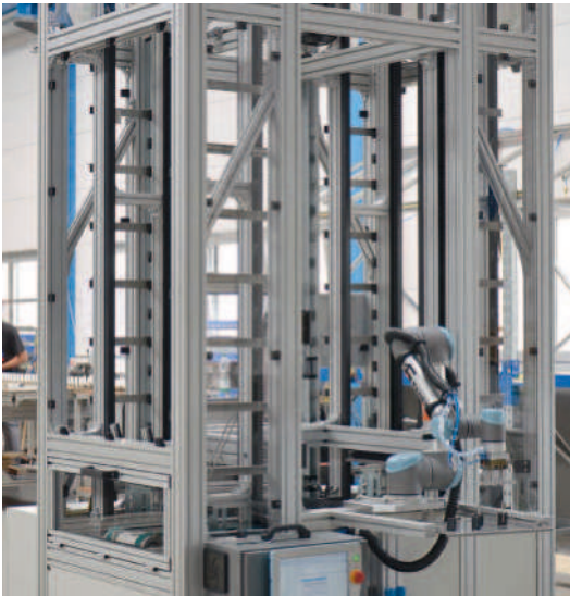
Hub-Speichersystem für Werkstückträger mit zwei gegenläufigen Kettenförderern und WT-Aufnahmen
