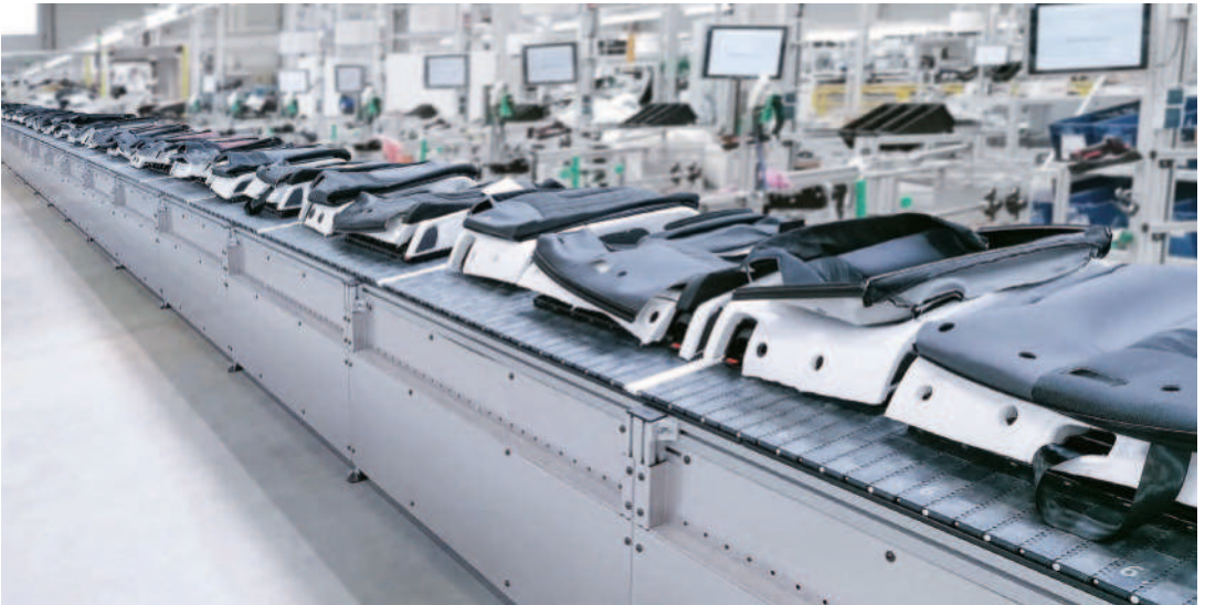
42 m langer MBF-P 2040 mit seitlichem Unterkriech- und Eingreifschutz für Just-in-Sequence-Montage am laufenden Band
