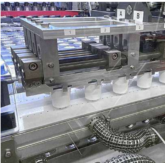
Vakuum-Gurtförderer für einen schnellen und getakteten Transport von Kunststoffbechern
