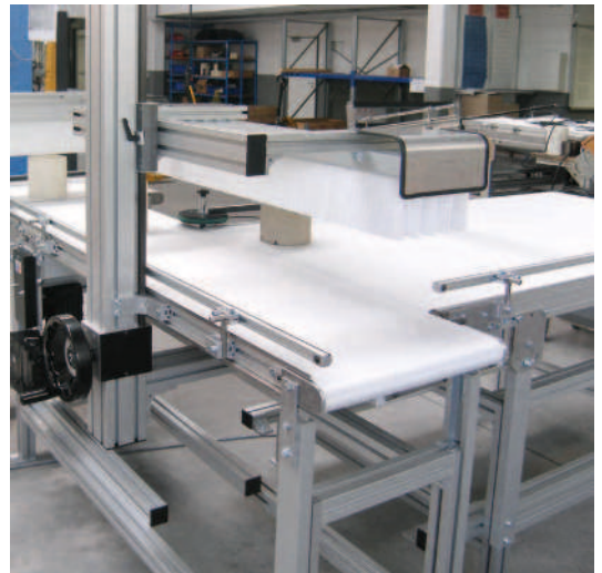
GUF-P 2000 mit integrierter Verstelleinheit (VST 2011) zur Höhenverstellung der Abstreiferbürsten
