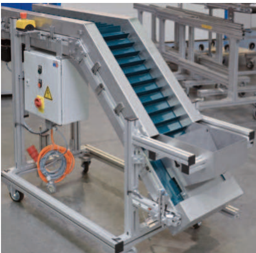
Mobiler KFG-P 2000 Typ K mit Seitenführung SF 9.1 (VA-Blech gekantet) und Übernahmetrichter am Bandanfang inkl. Steuerung
