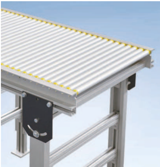
Rollenbahn Schwerkraft RBS-P 2065 mit Aluminiumrollen \varnothing 20 und Ständer 53.1
