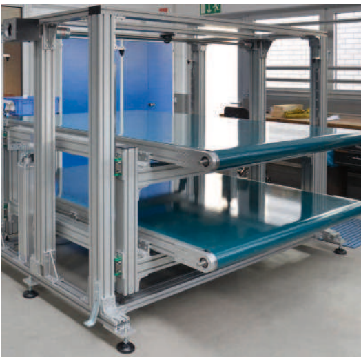
C-Gestell mit Kugelumlauf Führungen mit je 2 Laufwagen zum Heben bzw. Absenken der GUF-P 2004 Förderer
