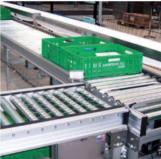
Transportbandkombination RBT-P 2255 mit integriertem Hub-Quer-Förderer
