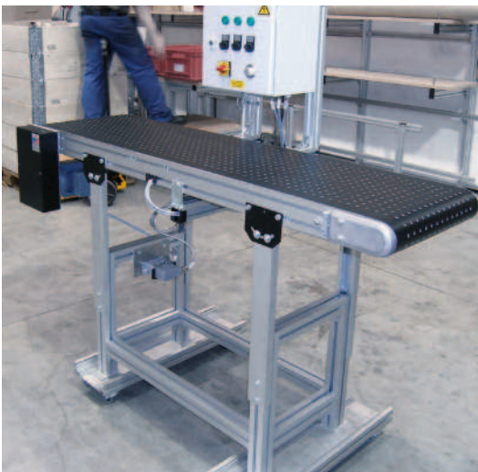
GUF-P 2041 mit Kopfantrieb AC und 90 Watt-Lüftern im Bandkörper, Reglomat oben am Bandkörper montiert
