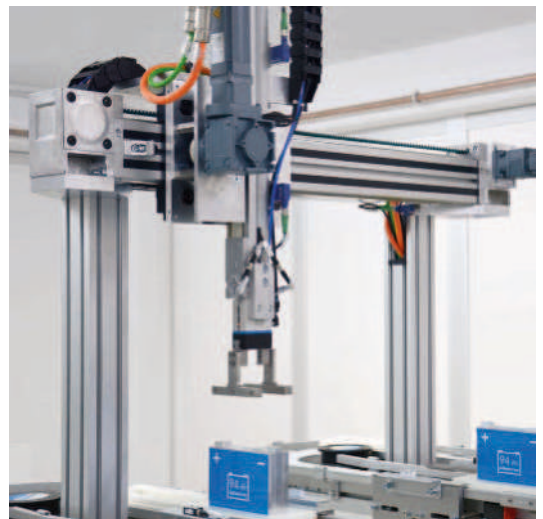
Zwei-Achs-Portal mit angetriebenen Linearmodulen, Greifer und Steuerung
