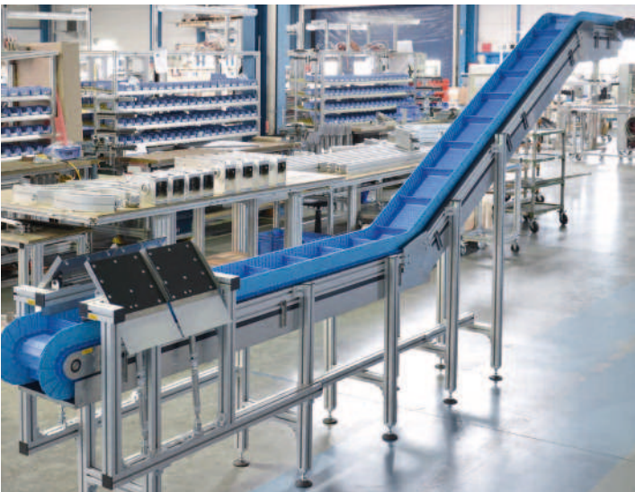
Knickförderer KFM-P 2040 mit Auffangwanne und Ausschleusklappe
