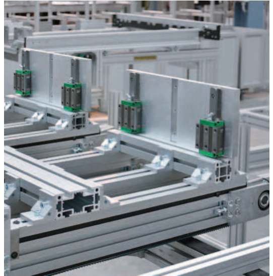
Hubeinheit mit Kugelumlaufführung KU 25 und Konsole
