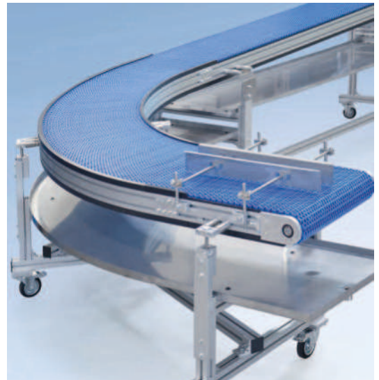
Kurvengängiger Modulbandförderer KMF-P 2040 mit Auffangwanne und fahrbarem Ständer
