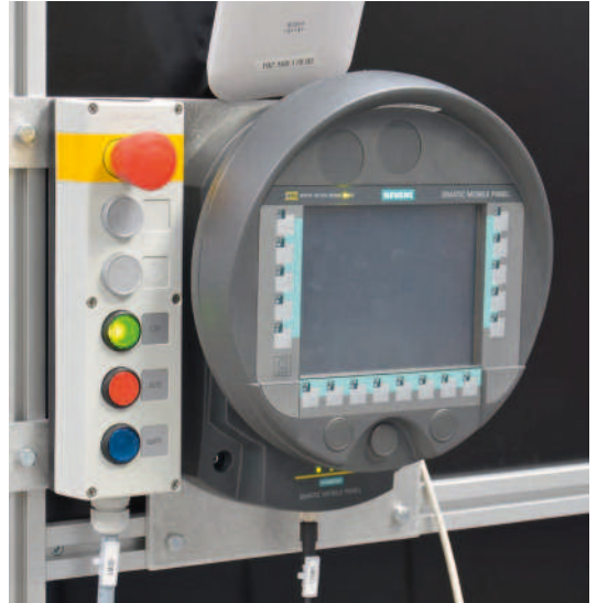
Türwahl mit Not-Halt Taster und mobiles Bedienpanel
