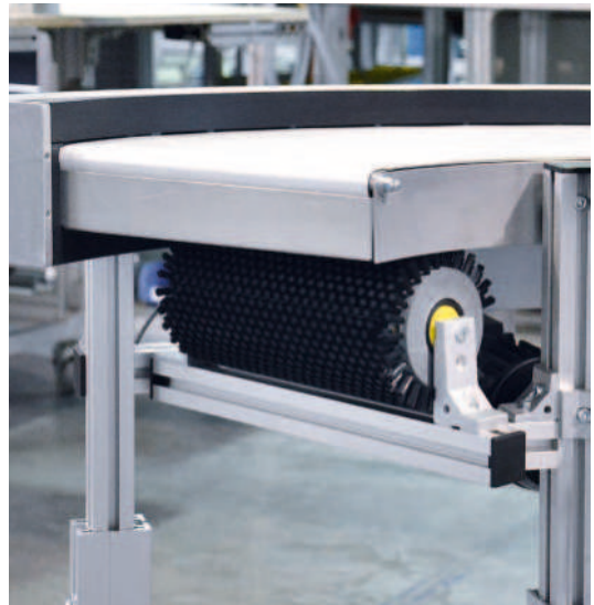
Abstreiferbürste, rotierend, am Bandende montiert
