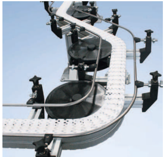
Scharnierbandförderer SBF A08 mit rollenden Kurven und Seitenführung
