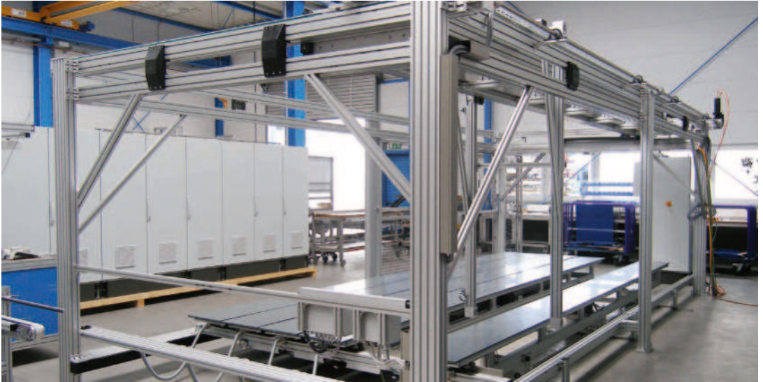
X-Y-Z-Handling Portal zur regelmäßigen Überwachung von Pflanzenwachstum
