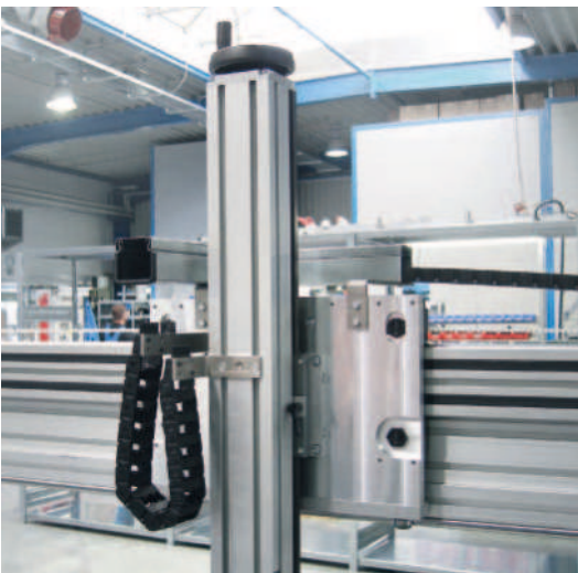
Basis LZR 2005-38.44-30 mit seitlichem Laufwagen auf geschäumten Kombiprofil als Portal, mit Stützrollen zur Momentenaufnahme und manueller VST 2011 als Z-Achse
