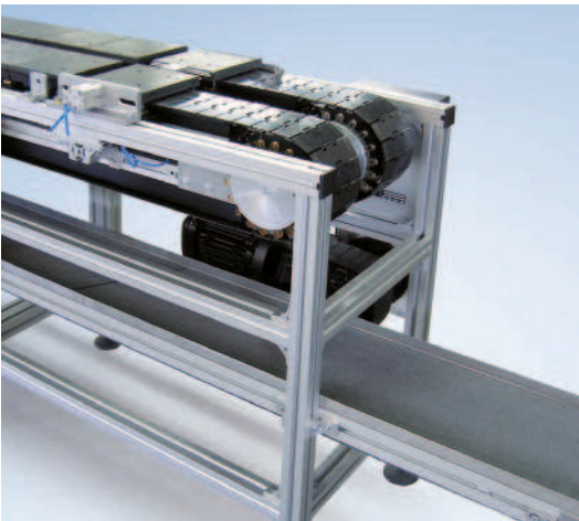
Verkettung 2-Strang Paletten-Umlaufsystem mit Gurtförderer GUF-P 2000 als Abführband für n.i.O Teile
