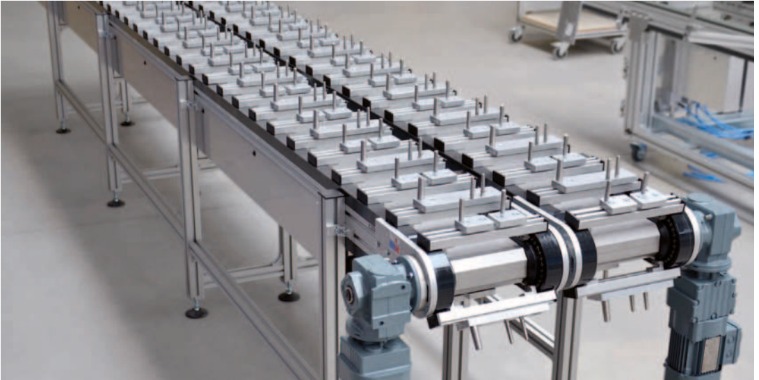
TKU als Zweistrang-System mit auftragspezifischen Profil-WTs und Aufnahmen
