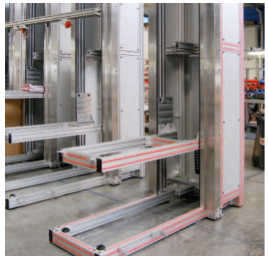
Doppel-Linearmodul Typ LZR 2005-38.44-30 mit Ausleger für Förderer als Lifteinheit
