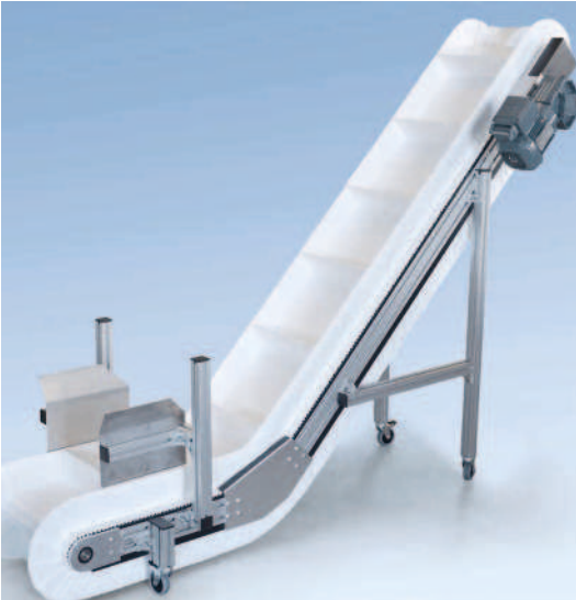
Knickförderer Modulband KFM-P 2040 Typ L mit Kopfantrieb AS, Ständer Typ ECO und Blecheinweisern am Einlauf
