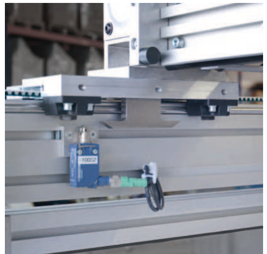
Lineareinheit LZR 2004-38.41-30 mit gekoppeltem Antrieb über Klauenkupplung
