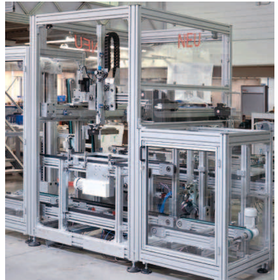
WT-Umlaufsystem Versamove plus für verschiedene Transportebenen mit 3-Achs Portal
