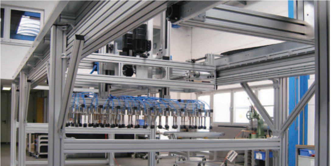
X-Z-Portal mit Vakuumbreifer als Handling- und Beladesystem von Stahlblechen. Zwei unabhängige Beladesysteme auf gemeinsamer X-Achse mit Zahnstange, mit Laufrollen und mitfahrendem Zahnstangenantrieb
