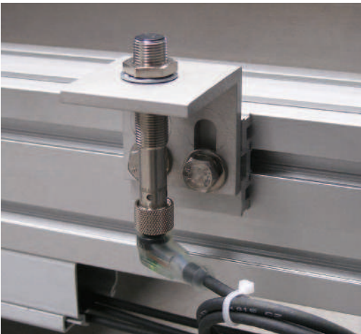
Initiatorhalter aus Aluminiumwinkel
