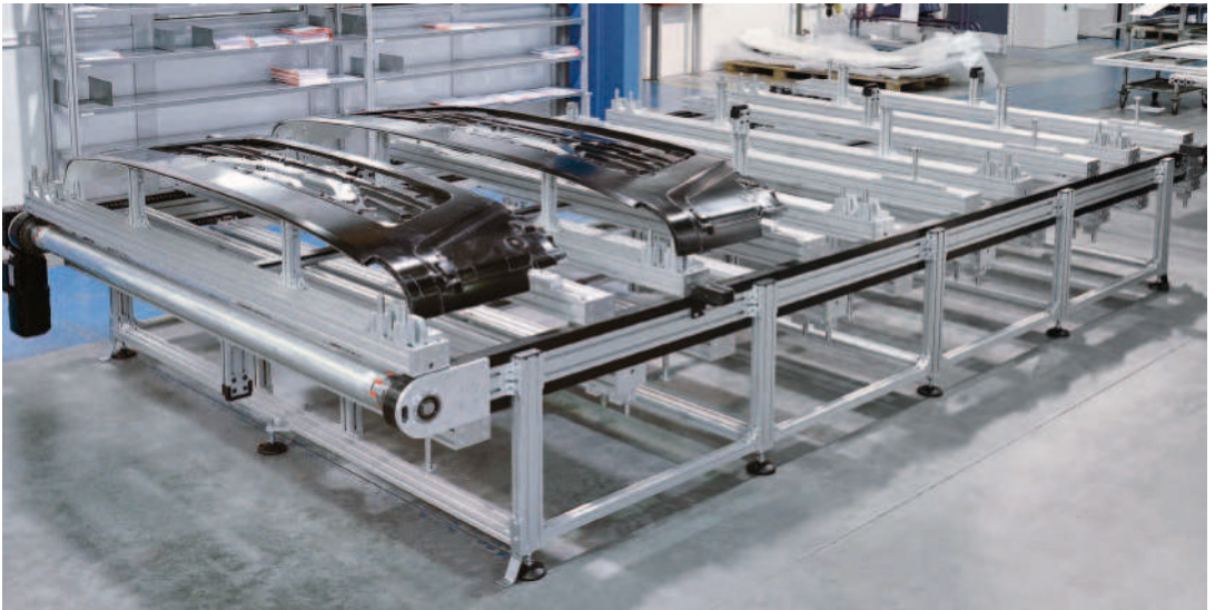
Taktfähiges Kettenumlaufsystem TKU 2040 mit individueller Werkstückaufnahme und Zentrierung für die Automotive-Branche
