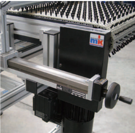
Doppelte VST 2015 mit manueller Digitalanzeige zur Einstellung der Anschlagleiste
