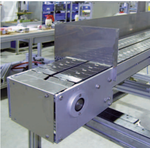
Doppelstrang-Scharnierbandförderer SBF-P 2254 mit robuster Stahlkette
