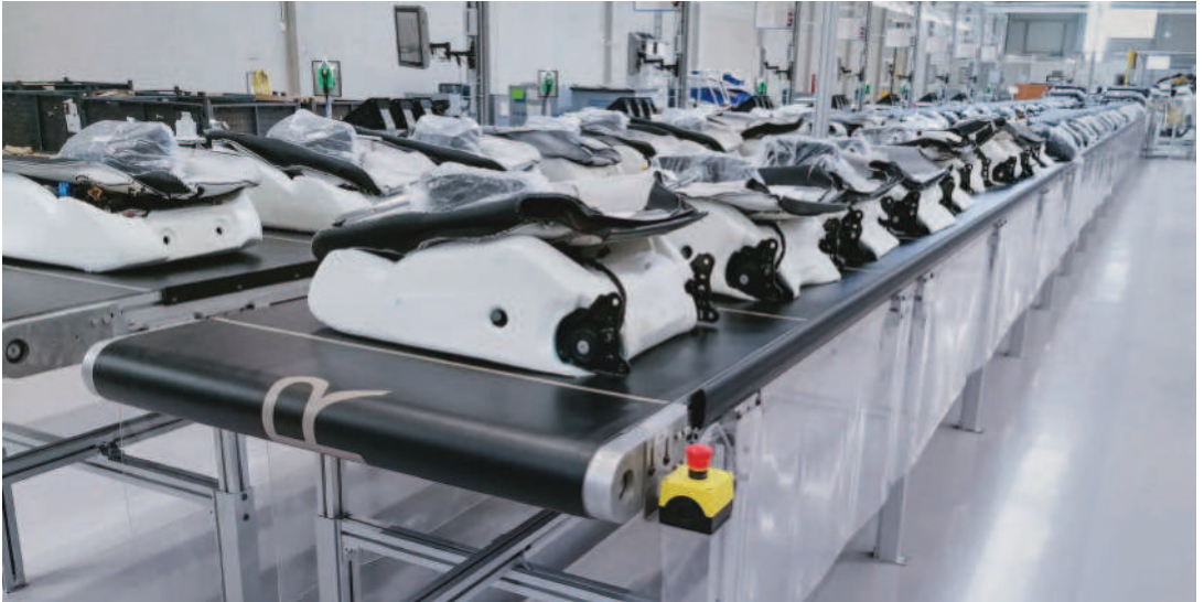
45 Meter langer GUF-P 2004 als Zuführlinie in der Just-in-Sequence-Produktion von Autositzen
