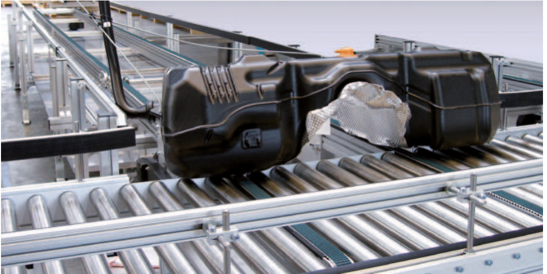
RBT-P 2255 mit integriertem Hub-Quer-Förderer, Belastbarkeit 100 kg/m mit zusätzlicher Seitenführung und Auffangwanne
