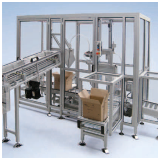
Anlage zur Befüllung von Kartonagen mit Verkettung der vorgelagerten Tuben-Füllstation und Integration der beigestellten Waage mit n.i.O.-Ausschleusung
