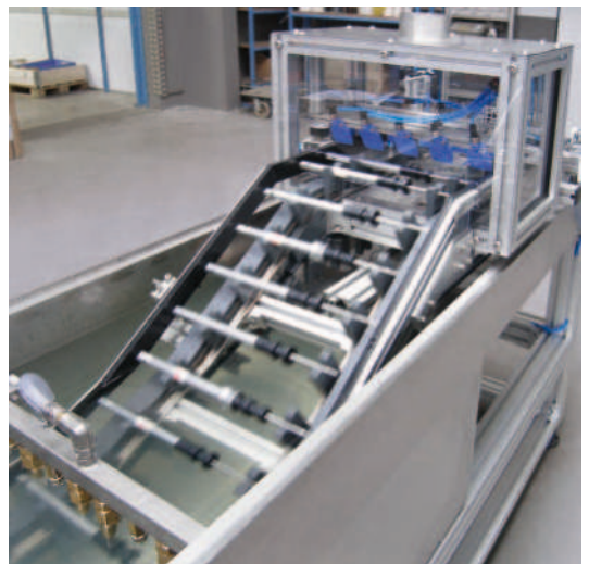
TKU 2040 mit 20° Neigung und Transport durch ein Reinigungsbad
