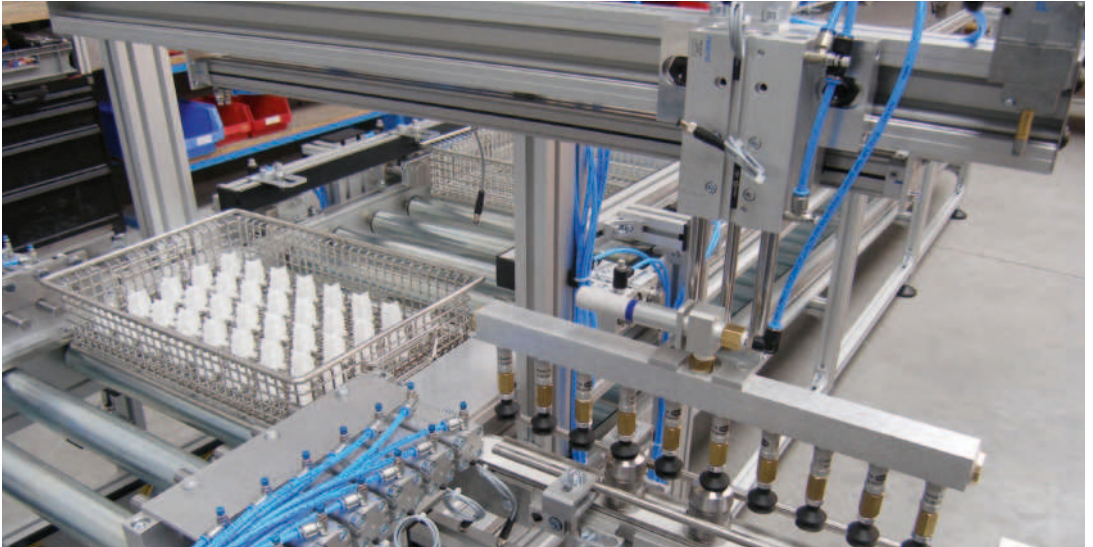
Pneumatisch angetriebenes Linearmodul mit PF 38.77 und LW 38.77-44 als Übersetzereinheit mit 10-fach Greifer über Vakuumsauger
