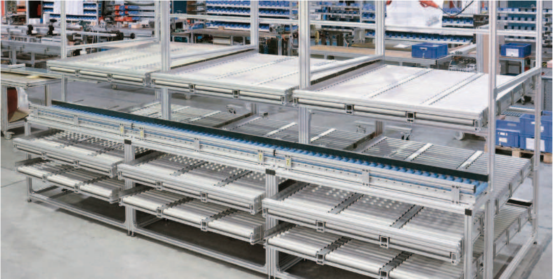
Kanban Arbeitsplatz mit Schwerkraftrollenbahnen RBS-P 2065 zur Zuführung
