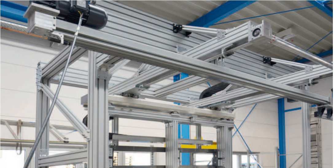
Zwei-Achs-Portal zum Hülsenhandling mit Parallelgreifer
