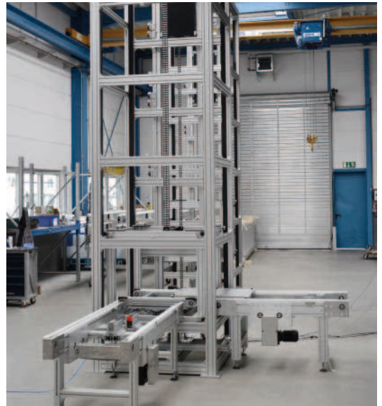
Hublift dreiseitig zugänglich, mit Drehkranz im Fahrkorb und Zuführung über Versamove ultra
