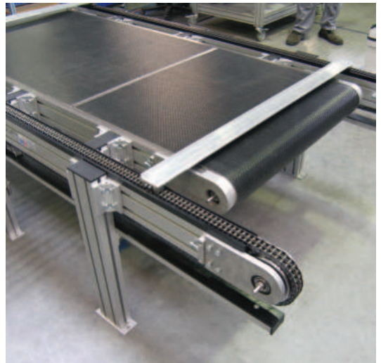
Förderbandkombination aus GUF-P 2004 mit Trommelmotor CA und 2-Strang-KTF-P 2004
