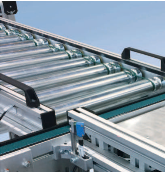
Rollenbahn Motorrolle RBM-P 2255 als Wartungszugang
