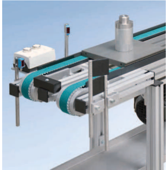
ZRF-P 2010 mit Lichtschranken zur Abfrage und Taster zum Ein- und Ausschleusen des Bauteils
