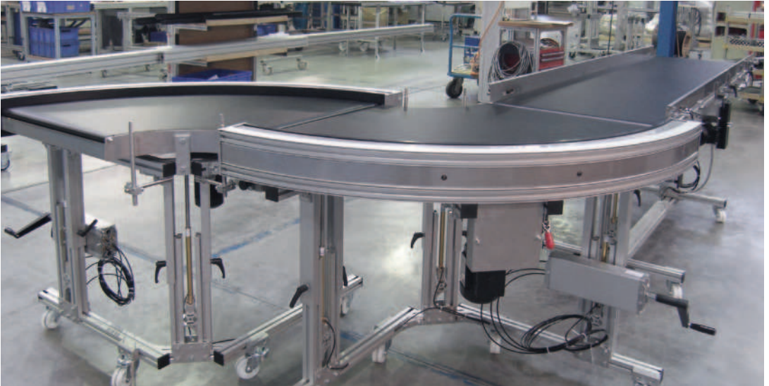
KGF-P 2040 mit Untergurtantrieb BI und hydraulischer Höhenverstellung der Ständer über Handkurbel
