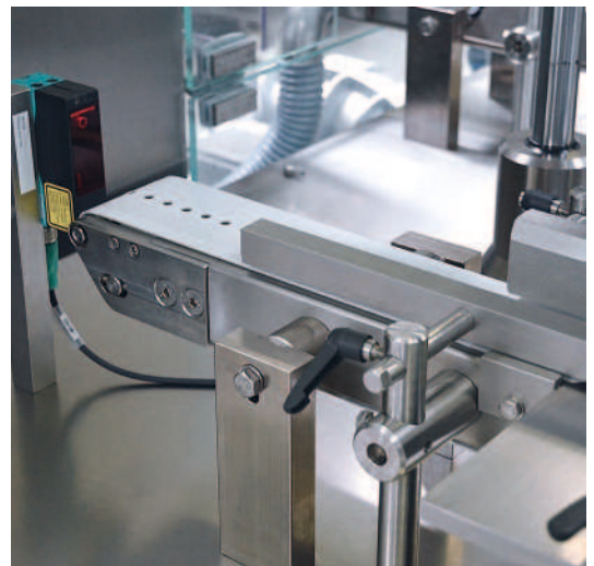
INOX Vakuum-Gurtförderer mit individueller Seitenführung
