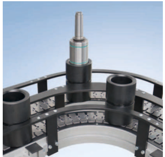
SBF-P 2254 mit 90° Kurve gleitend und Stahlkette als Verkettungseinrichtung für Wellenteile
