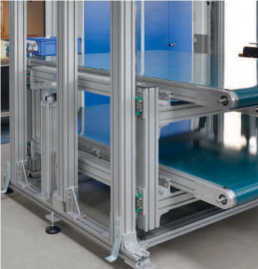
Liftstation zum Heben bzw. Absenken der Förderer in zwei Förderebenen. Querverfahrenheit mit Kugelumlaufführungen horizontal im Gestell
