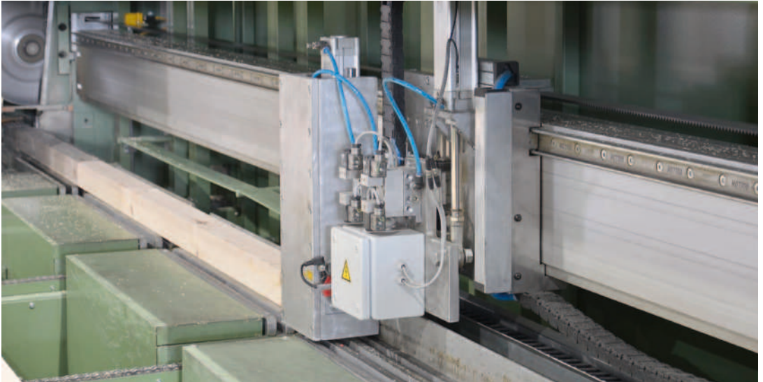
Linearmodul LZR Serie 60 auf Basis des Profils mk 2060.07 mit Laufrollen und Schienen der Fa. Rollon
