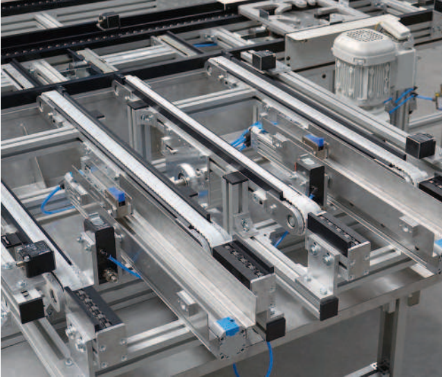
Eckübersetzer mit Bauteilkontrollen und Endlagenabfrage
