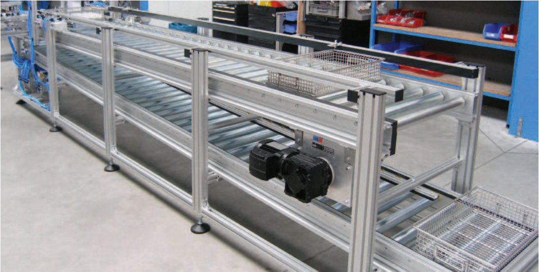
Friktions-Rollenförderer RBT-P 2255 mit Schwenkförderer als Liftfunktion zum Rückführen der leeren Körbe
