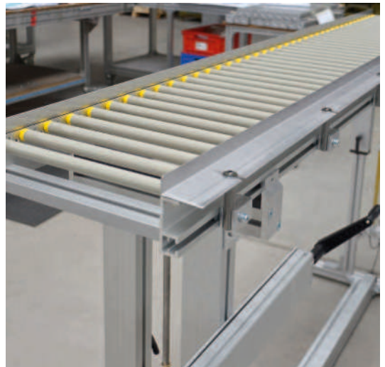
Schwerkraftrollenbahn RBS-P 2066 mit höhen- verstellbarem Ständer und Winkelblech als Seitenführung
