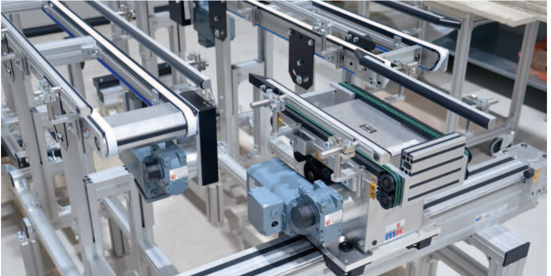
Doppelgurtförderer DGF-P 2001 mit Seitenführung SF02 und Schüttlesystem über Laufrollenführung
