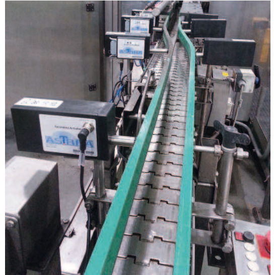
Versaflex Edelstahlförderer mit automatisch verstellbarer Seitenführung ASTRA
