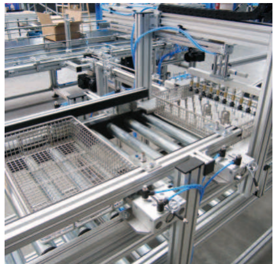
Zu- und Abtransport für eine kundenseitige Mess- und Verpackungseinrichtung
