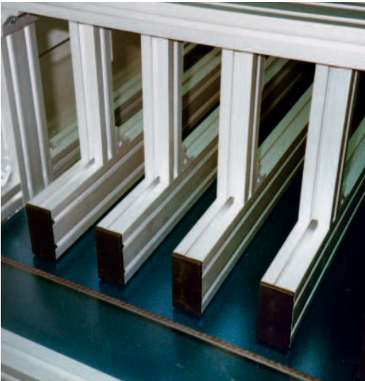
Mehrspurig einstellbare Seitenführung in Portal-Anordnung
