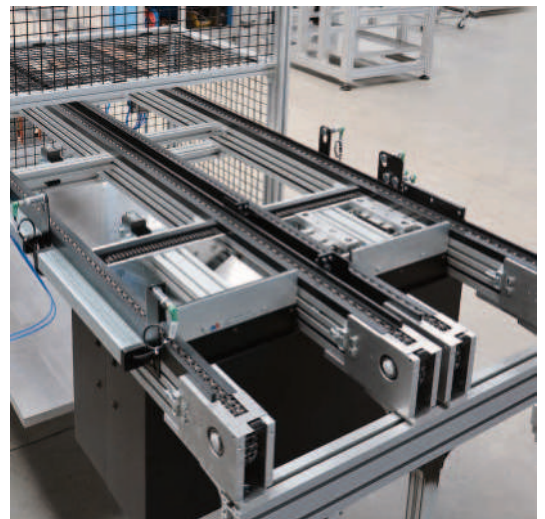
Hub-Querförderer mit Kette und einem gekoppelten Antrieb zur automatischen Produktentnahme mit Indexierung von unten
