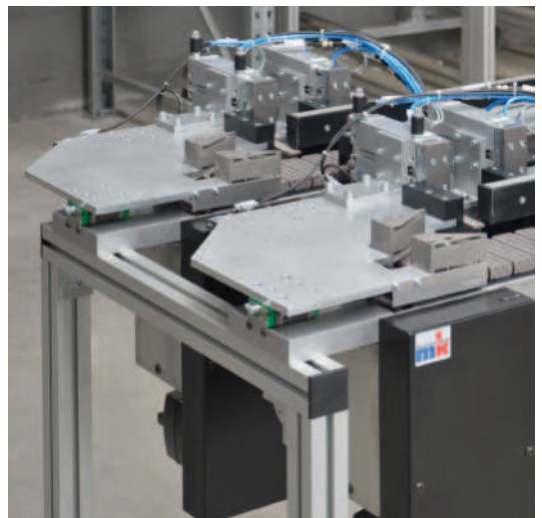
Zweispurige Zuführung zur Maschinenbeschickung. Die Einstellung der Vereinzelung für verschiedenen Durchmesser erfolgt über eine Kugelumlaufführung
