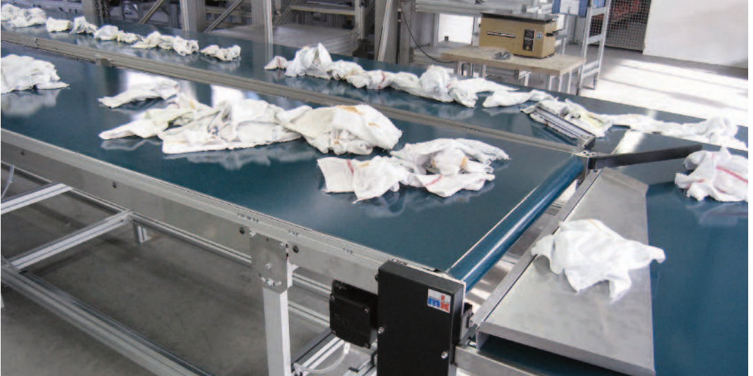
Umlaufsystem zum manuellen Sortieren von Wäsche auf Basis GUF-P 2041 und GUF-P 2000 Förderern mit Kopfantrieb AC
