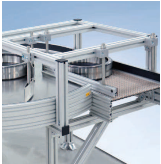
Drehtisch DT-P 2040 mit manuell einstellbarer Ausschleusung für Bauteile
