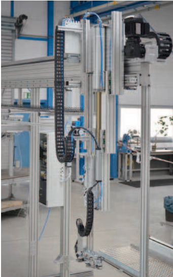
Portalständer mit teleskopierbarer Greifereinheit
