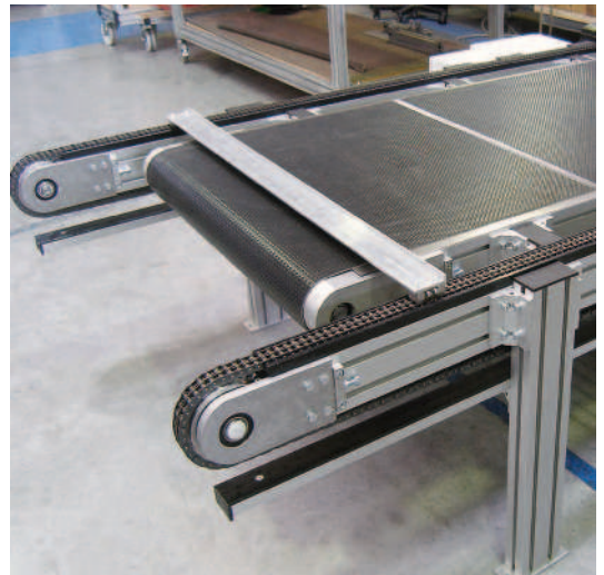
Kombination aus Gurt- und Kettenförderer mit Querschiene zur Simulation eines Bodenhindernisses
