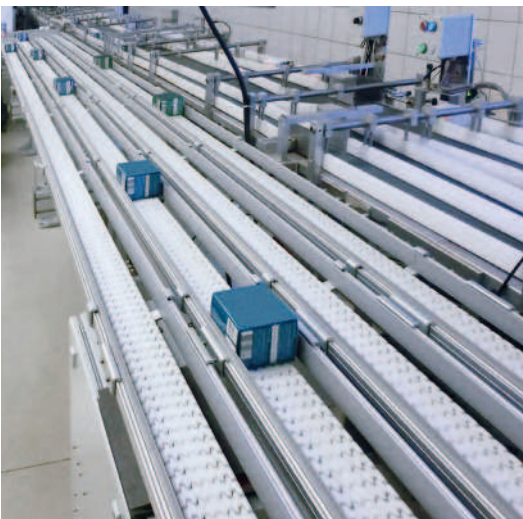
Versaflex SBF als paralleles Mehrstrangsystem
