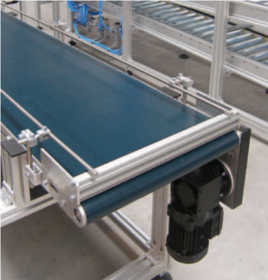
Gurtförderer GUF-P 2000 AC mit Staubügel am Bandende
