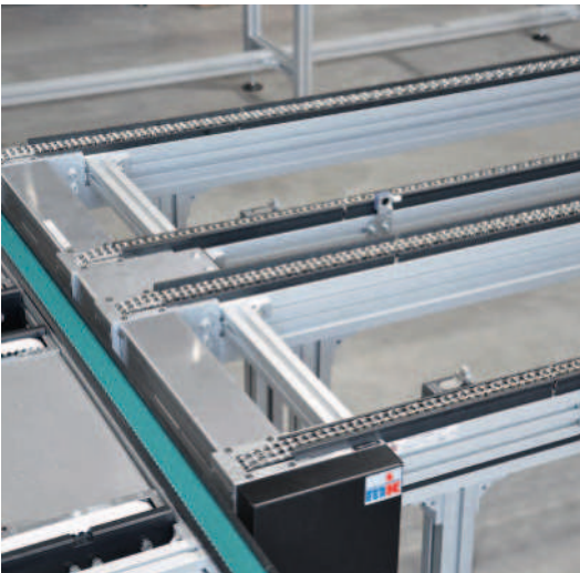
Doppelspuriger KTF-P 2010 mit einer Temperaturbeständigkeit von 80°C
