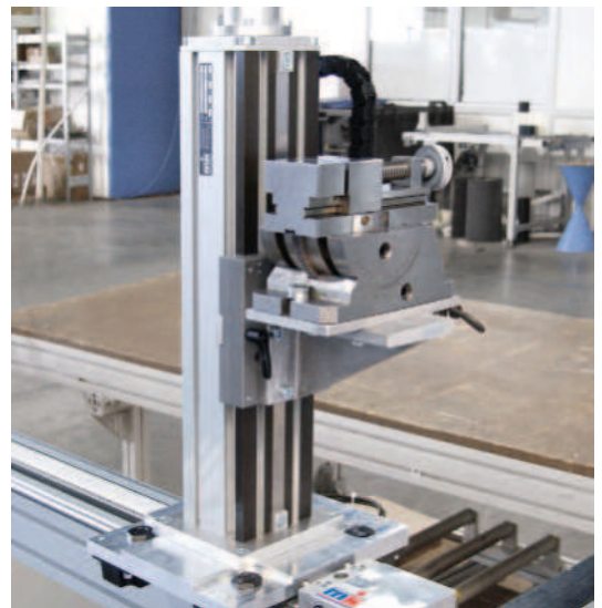
Elektromotorische VST 2011 mit kundenspezifischem Meßsystem auf LZR 2005-38.44-30
