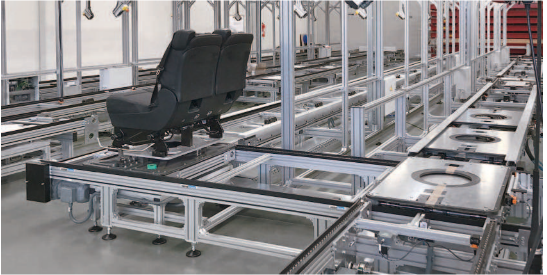
Versamove plus mit großformatigen kundenindividuellen Werkstückträgern
