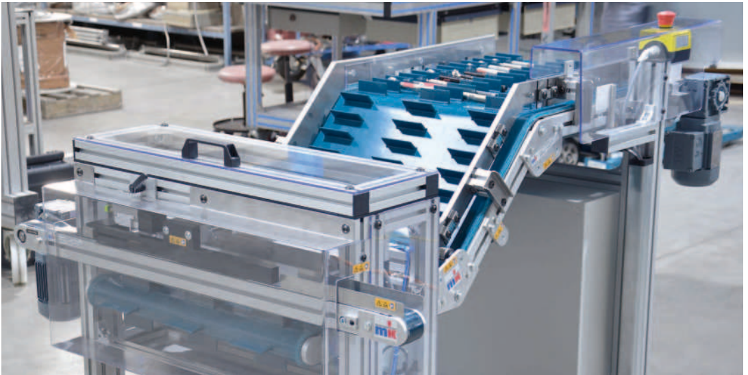
KFG-P 2000 mit geschützter Teileabfrage zum Abtransport und zur Pufferung für eine Produktionsanlage
