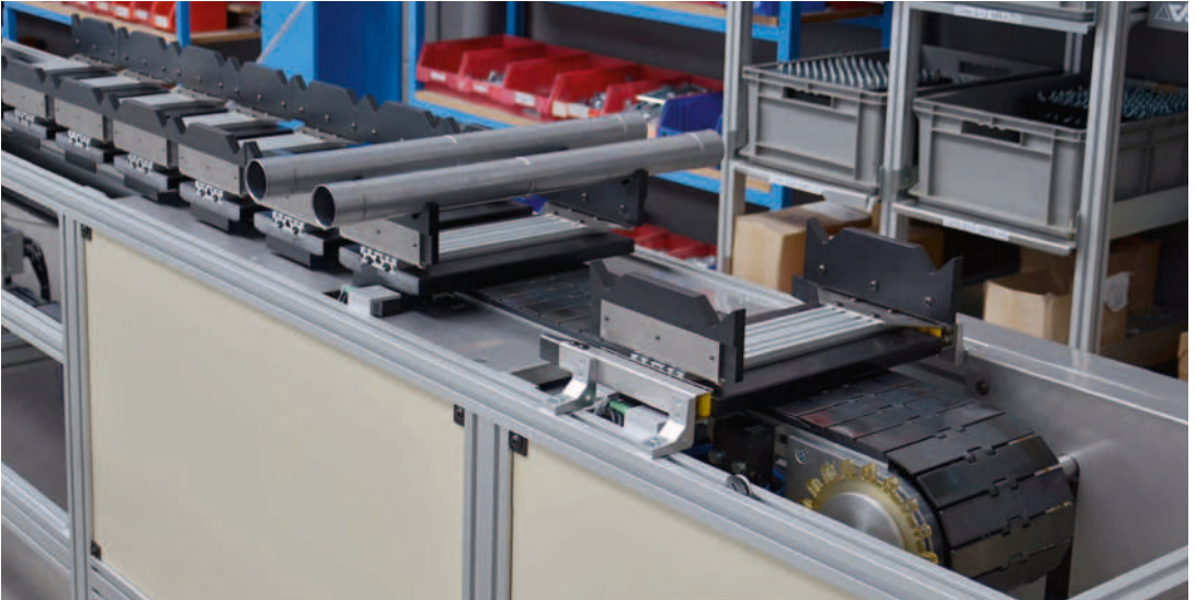
Staufähiges Palettenumlaufsystem SPU mit WT-Vereinzelungsfunktion als Teilezuführung für eine Produktionsanlage
