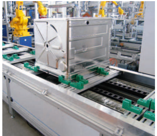
SPU Doppelstrang als Zuführband für Spülmaschinegehäuse
