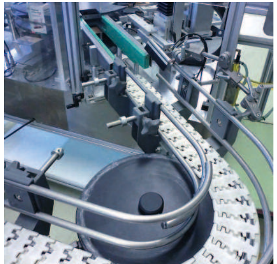
Versaflex Scharnierbandförderer mit rollenden Kurven und Seitenführung
