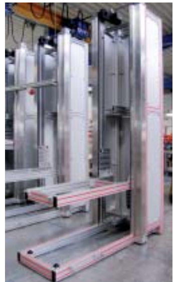
Lift aus Linearmodul LZR 2005-38.44-30 mit auf den Laufwagen montierter motorisch angetriebener Verstelleinheit
