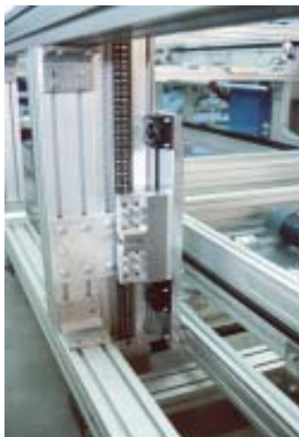
Linearmodul mit Duplex-Kette auf Basis LZR 2005-38.44-30 als Lift für Paletten-Transport
