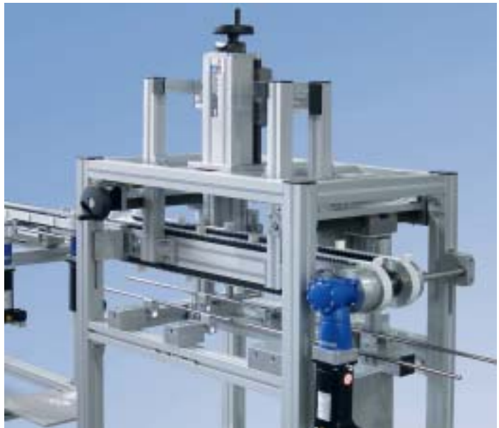
VST 2011 zur manuellen Einstellung der Förderhöhe und doppelte VST 2015 mit Koppelung über Zahnriemen zur Breitereinstellung des Taktförderers ZRF-P 2040.02
