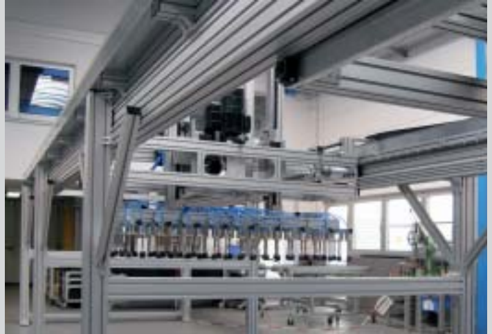
X-Z-Portal mit Vakuumgreifer als Handling- und Beladesystem von Stahlblechen. Zwei unabhängige Beladesysteme auf gemeinsamer X-Achse mit Laufrollen und mitfahrendem Zahnstangenantrieb
