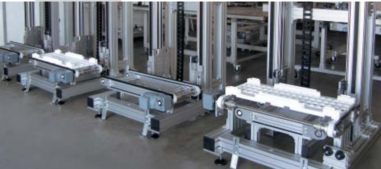
Lifte mit 2-Strang-Zahnriemenförderer auf Basis LZR 2005-38-44 mit innen angeordneten Laufwagen
