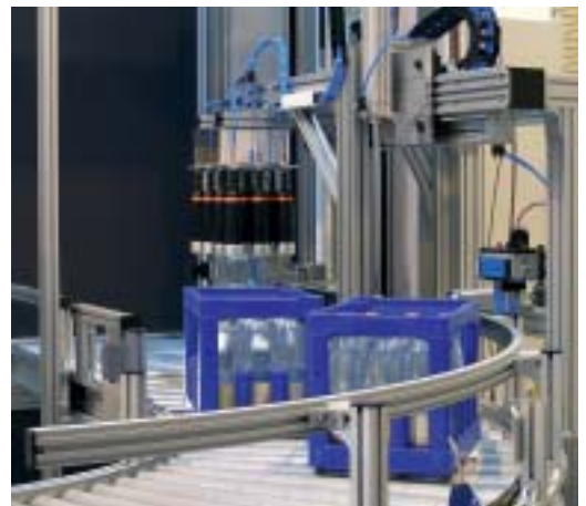
X-Z-Achskombination mit Pneumatikantrieb und Vakuumsauger zur Be- und Entladung von Getränkeketten
