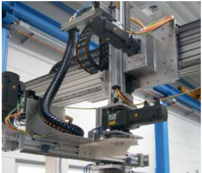
X-Y-Z-Portal zur Maschinenbeladung mit Schwenkachse und Vakuum-Greifer
