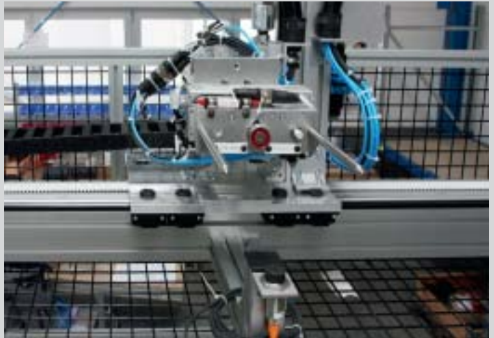
Horizontalschlitten bestehend aus Linear- modul LZR 2005-38.44-30 mit Gabelgreifern zum Umsetzen und Entleeren von Werkstückkörben
