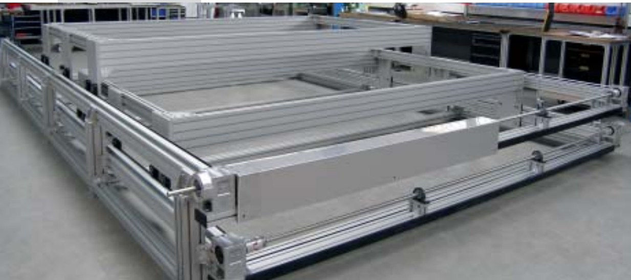
Doppel LZR 2011 -38.44-30 als Wechseltisch für Rohmaterialplatten. Produktwechsel in zwei Ebenen übereinander
