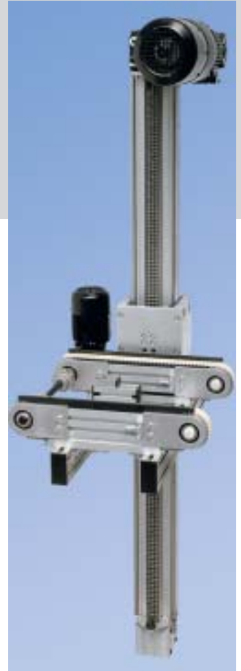
Linearmodul mit Doppellauf- wagen, Drehstrom-Asynchro- ngetriebemotor und Triplex-Kette als Lift mit Zahnriemenförderer
