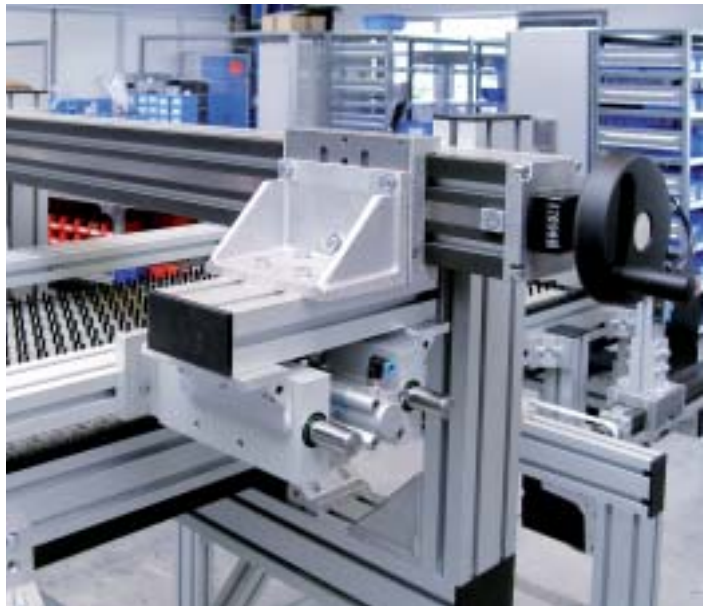
VST 2011 mit Digitalanzeige zur Breitereinstellung der pneumatischen Zentriereinheit am Modulbandförderer
