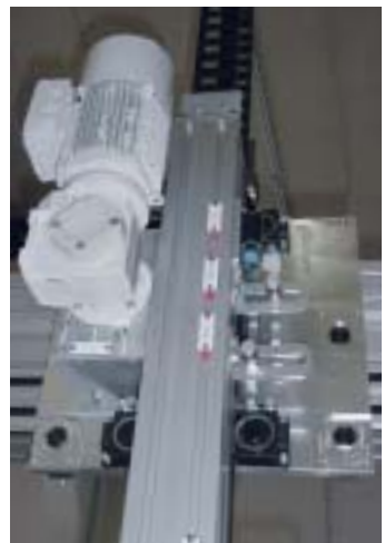
Zweiachs-Anwendung, Z-Achse mit Kreuzlaufwagen und Omega-Antrieb
