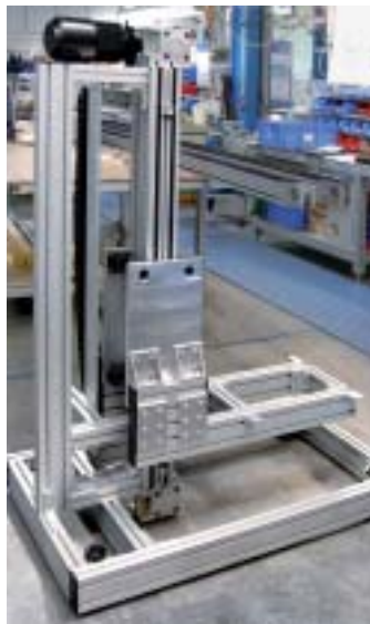
Lift mit synchronem Förderband zum Transport von Plastikboxen. Linearmodul LZR 2005-38.44-30 mit zwei seitlichen Laufwagen
