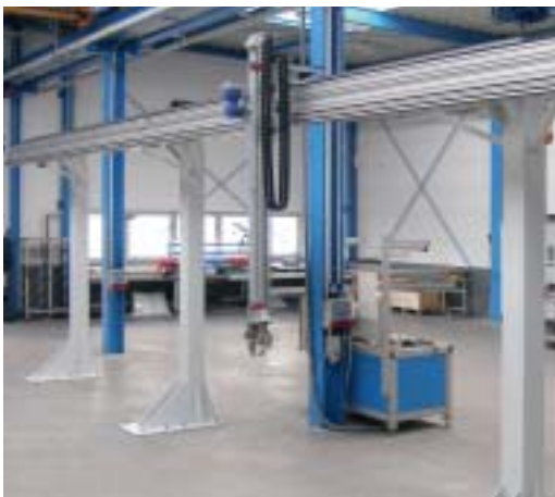
X-Z-Portal mit Greifer zum Umsetzen von Kurbelwellen. X-Achse als LZR mit Stützrolle und Zahnriemen, Z-Achse mit Zahnriemen-Omegaantrieb und Fallsicherung
