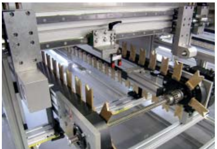
Lineareinheit zur manuellen Spurbreitenverstellung und Klemmung des pneumatischen Zentriers und der elektomotorischen Dreheinheit
