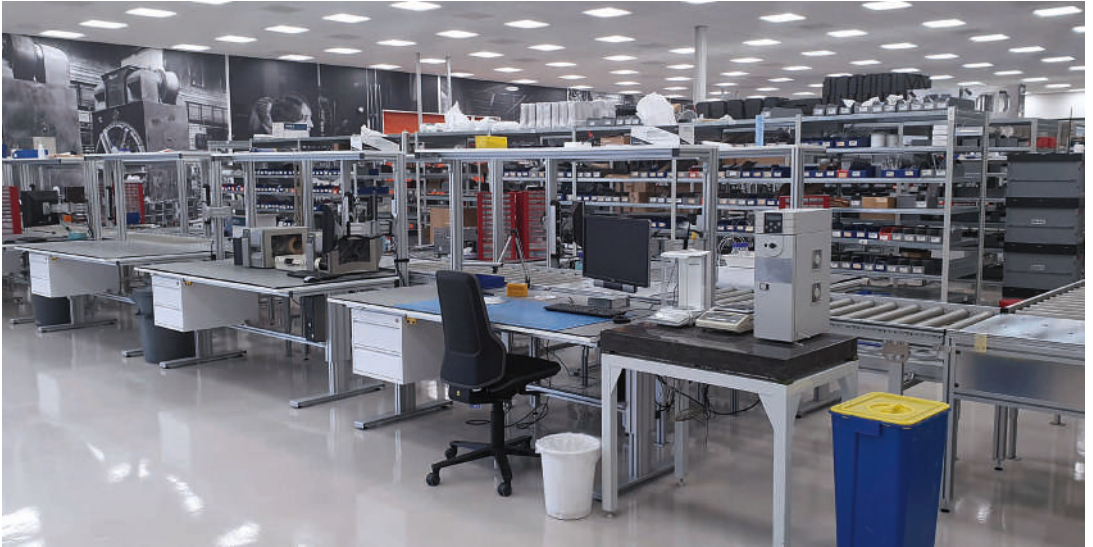
ESD konforme Montage- und Prüflinie mit integrierter Förderstrecke für Analyseeinheiten
