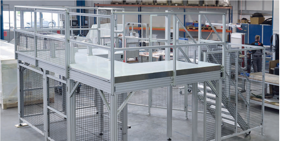
Podest aus Profilerie 40 mit Flächenelementen aus Schweißgitter
