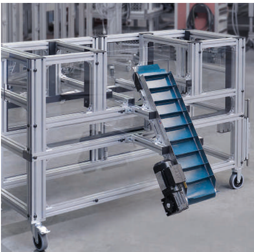
Fahrbares Gestell mit integriertem Förderband zur Zuführung von KLT's
