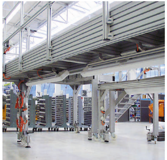
Die Profilmuten eignen sich für die Anbindung von Komponenten, wie z.B. der Elektronikversorgung
