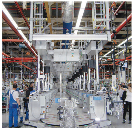
Überbau aus Profilen der Serie 40 als Versorgungsträger für Montagearbeitsplätze
