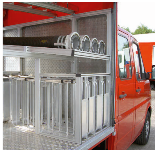
Innenausbau für Feuerwehrfahrzeug aus Profilen der Serie 25
