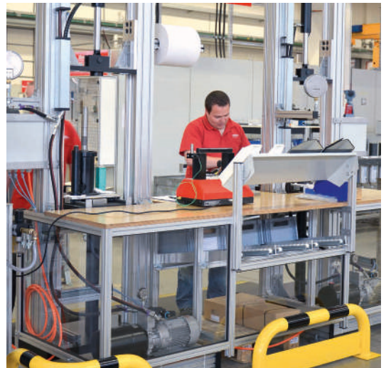
Montagearbeitsplatz mit integrierter Presse und Dokumentenablage
