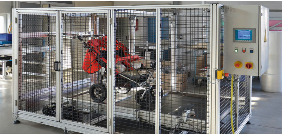
Individuelle Schutzeinrichtung für Prüfvorrichtung für Kinderwagen
