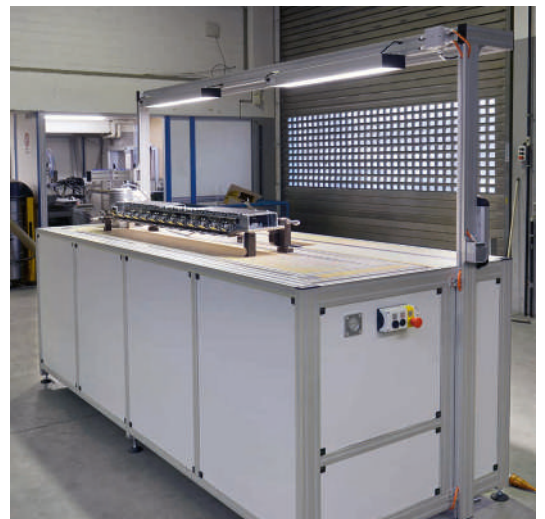
Montagearbeitsplatz mit Absenkvorrichtung über elektrisch angetriebene Hydraulikzylinder
