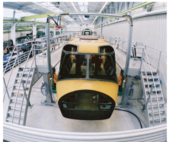
Podest um Wartungs- und Montagearbeiten an Helikoptern einfach und gefahrlos durchführen zu können
