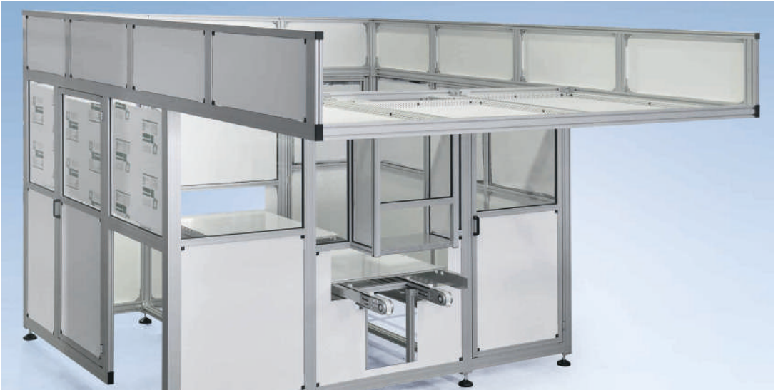
Individuelle Schutzeinrichtung für Fertigungsmaschine
