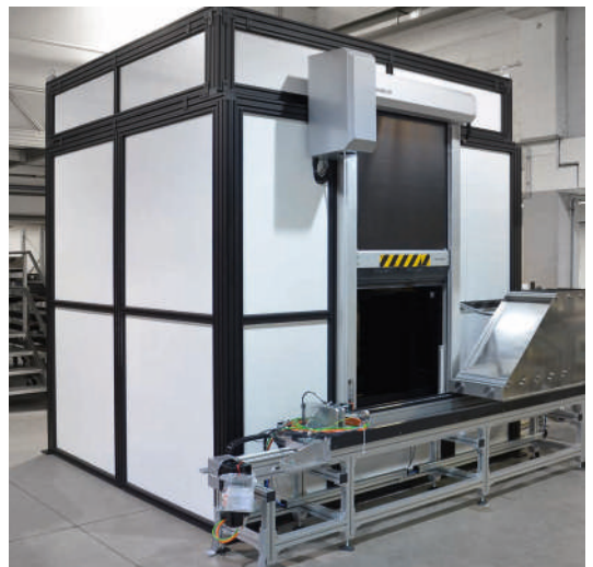
Messkammer aus schwarz eloxierten Profilen mit automatisierter Zu- und Abführung
