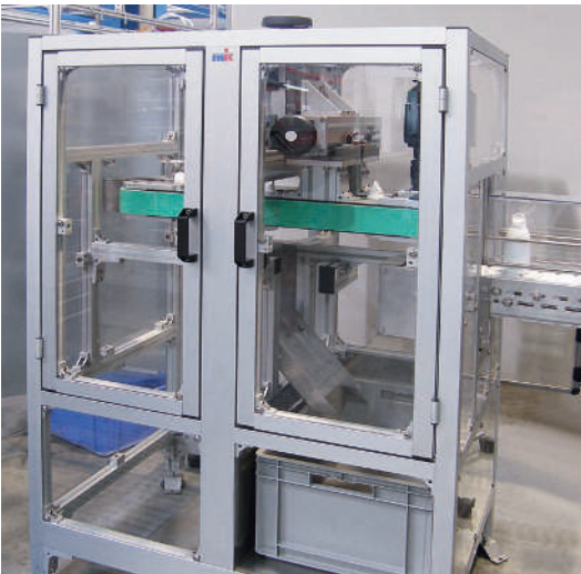
Schutzeinrichtung mit Flügeltüren aus Reinraumprofilen
