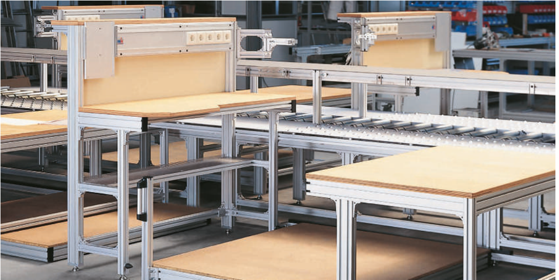
Industriearbeitsplätze inkl. Verkettung mit integrierter Elektroversorgung und angetriebener Rollenbahn
