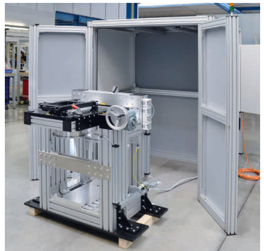
Schutzeinhausung für Wuchtstand, Zugang über Flügeltür mit Sicherheitsverriegelung und Sicherheitssteuerung für den Wuchtstand
