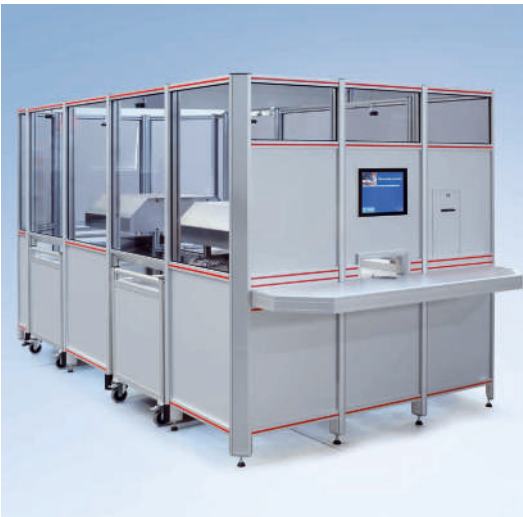
Schutzeinhausung mit Flächenmaterial aus Alucobond® und Polycarbonat
