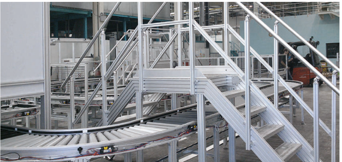
Freistehende Brücke zur Überbrückung einer Förderstrecke gemäß Arbeitsschutzrichtlinie (Verkehrswege)
