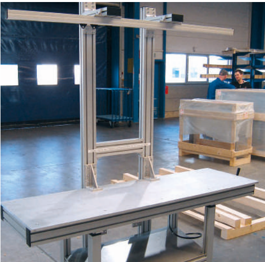
Montagearbeitsplatz manuell höhenverstellbar über Handkurbel, Belastung 600 kg
