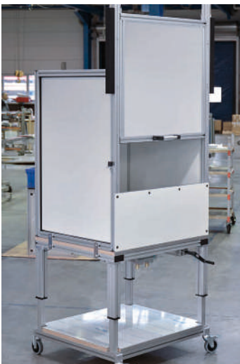
Arbeitsplatz mit Schutzhaube und manuell verfahrbarem Schiebelement
