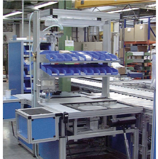
Industriearbeitsplatz in DFT-Fließmontagelinie für Vakuumpumpen
