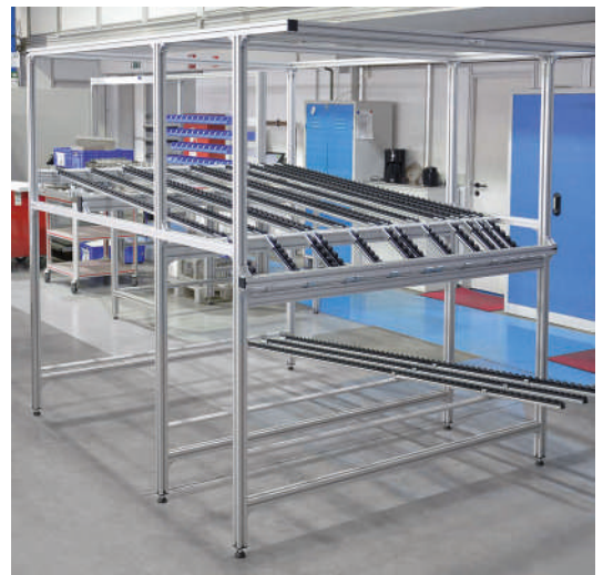
Kanban-Regal für Materialzufuhr über Röllchenbahnen und Leerkistenrücklauf
