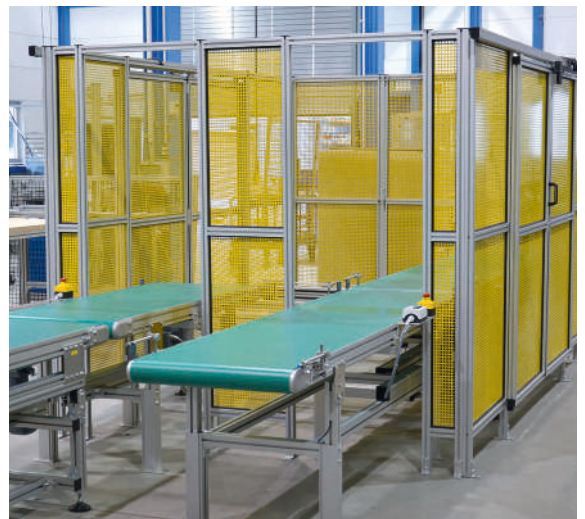
Individuelle Schutzeinhausung aus Feldern mit pulverbeschichteten Lochblechen und Schiebetüren mit Sicherheitszuhaltung
