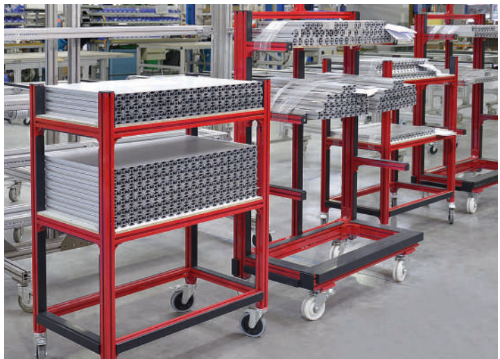
Bereitstellungswagen aus rot lackierten Profilen der Serie 40
