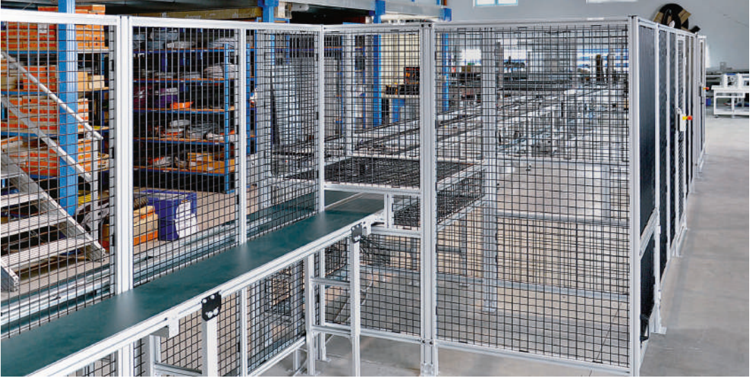
Schutzeinrichtung mit Schweißgitter (Feld-Lösung) für Tray-Transportanlage
