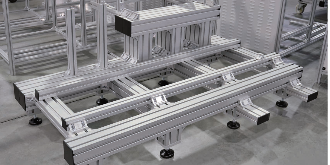
Grundkonstruktion besteht aus Profilen der Serie 40 und 60
